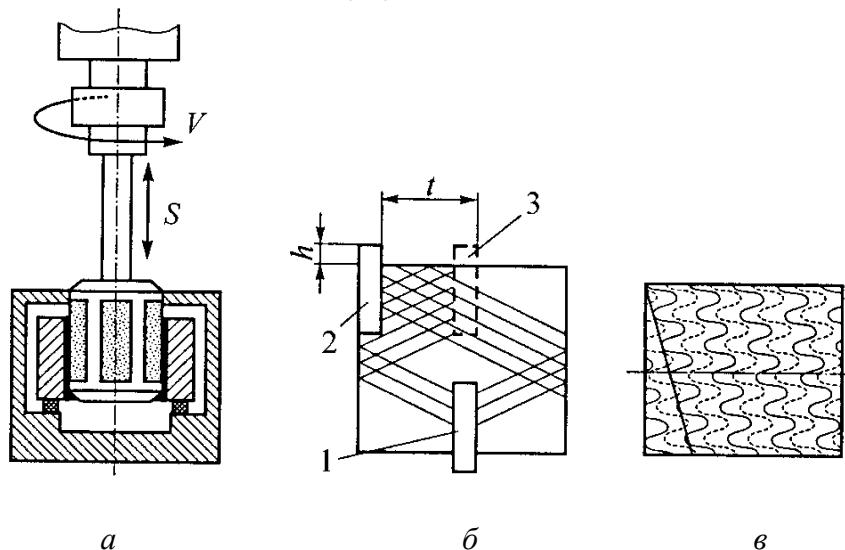
Рис. 10.69. Развертка обработанной поверхности: *а* – схема хонингования отверстия; *б* – обычное хонингование: 1, 2 – нижнее и верхнее положение брусков соответственно; 3 – смещение бруска на один шаг;  $h$  – перебег;  $t$  – шаг смещения брусков; *в* – вибрационное хонингование
