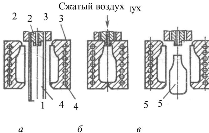
Рис. 9.10. Схема раздувки полых изделий: *a* – форма разомкнута; *б* – подача воздуха в форму; *в* – извлечение изделия
