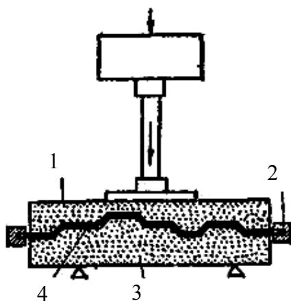
Рис. 9.15. Схема штамповки направленной вытяжкой: 1 – пuhanсон; 2 – зажимы; 3 – матрица; 4 – изделие
