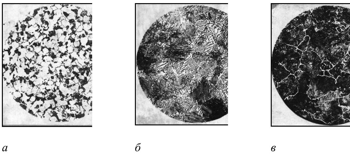
Рис. 2.22. Структура углеродистой стали:
