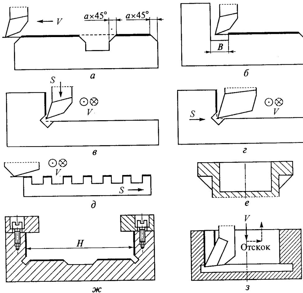
Рис. 10.58. Технологические требования к деталям, обрабатываемым строганием и долблением: *а* – прерывистых поверхностей; *б–г* – горизонтальных и вертикальных поверхностей с уступами; *д* – ребристых поверхностей; *е* – коробчатых нежестких заготовок; *ж* – пазов; *з* – несквозных шпоночных пазов; *V* – движение резания; *a* – фаска; *B* – ширина канавки для выхода инструмента; *S* – движение подачи; *H* – ширина паза
