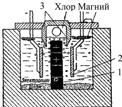
Рис. 3.11. Схема ванны для электролиза хлоридов магния
