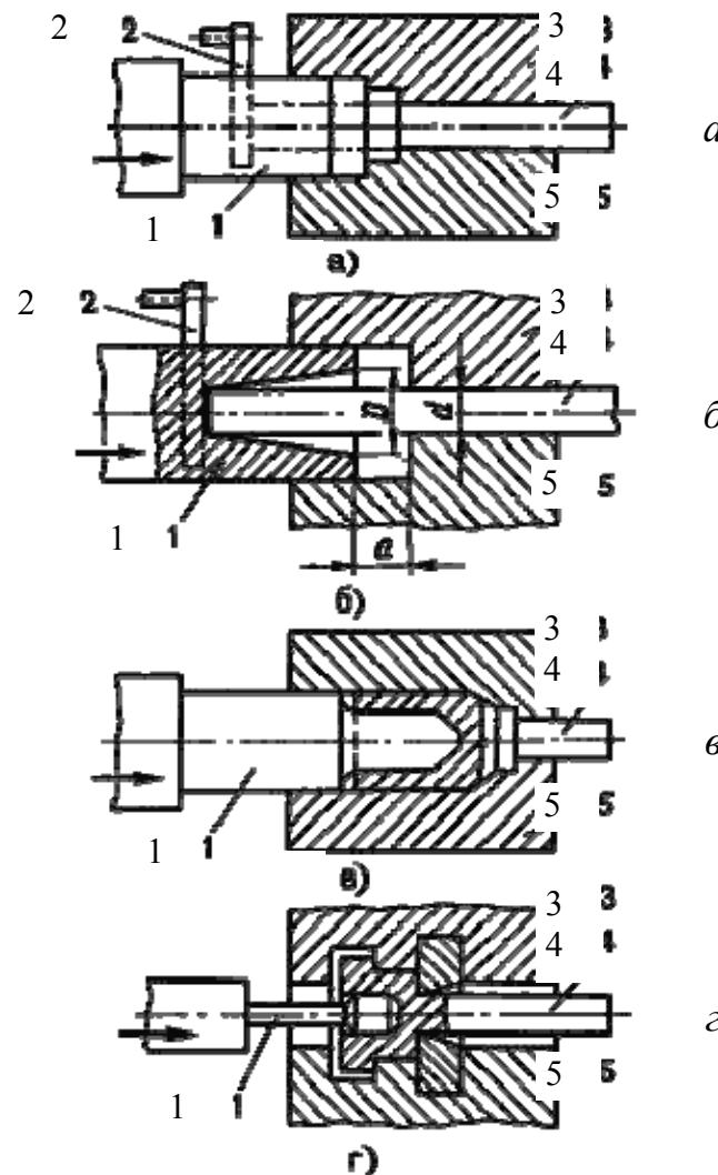
Рис. 6.50. Схемы операций при штамповке на горизонтально-ковочной машине:
