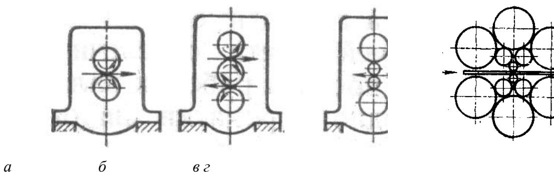
Рис. 6.21. Классификация прокатных станов по числу валков
