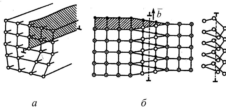
Рис. 2.7. Схемы краевой (а) и винтовой (б) дислокаций
