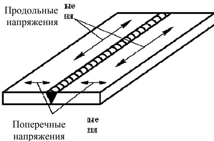
Рис. 7.31. Направления действия продольных и поперечных внутренних напряжений
