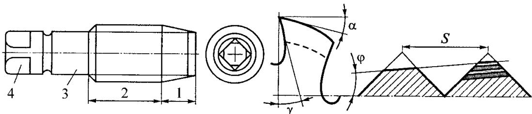
Рис. 10.60. Метчик: 1 – заборный участок; 2 – калибрующий участок; 3 – хвостовик; 4 – квадрат;  $S$  – шаг винтовой канавки
