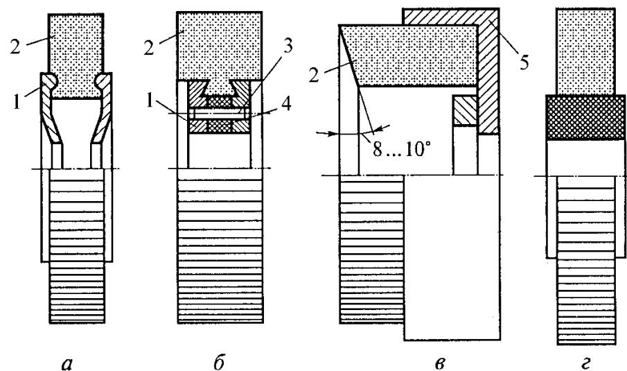
Рис. 10.70. Лепестковые полировальные круги: *а* – армированные неразборные; *б* – армированные разборные; *в* – торцевые; *г* – безарматурные; 1 – фланец; 2 – лепесток; 3 – болт; 4 – ступица; 5 – планшайба
