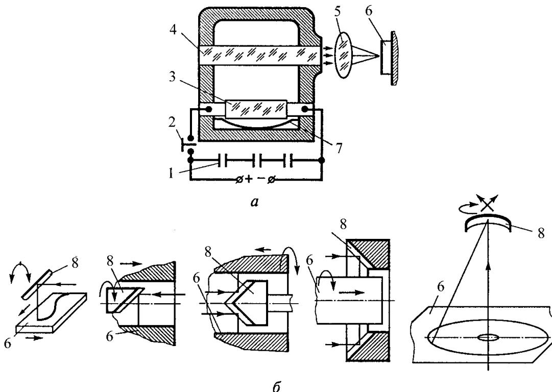
Рис. 11.9. Лазерная обработка: *а* – схема рубинового лазера; *б* – схемы управления лучом; 1 – батарея конденсаторов; 2 – пускатель; 3 – ксеноновая импульсная лампа; 4 – рубиновый стержень; 5 – оптическая система; 6 – заготовка; 7 – отражатель; 8 – зеркало
