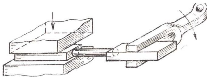
Рис. 6.41. Скручивание
