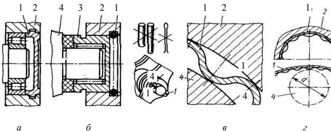
Рис. 13.3. Технологичные соединения изделий с использованием упругих деталей
