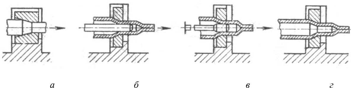
Рис. 6.28. Схемы волочения прутков (а) и труб (б–г)
