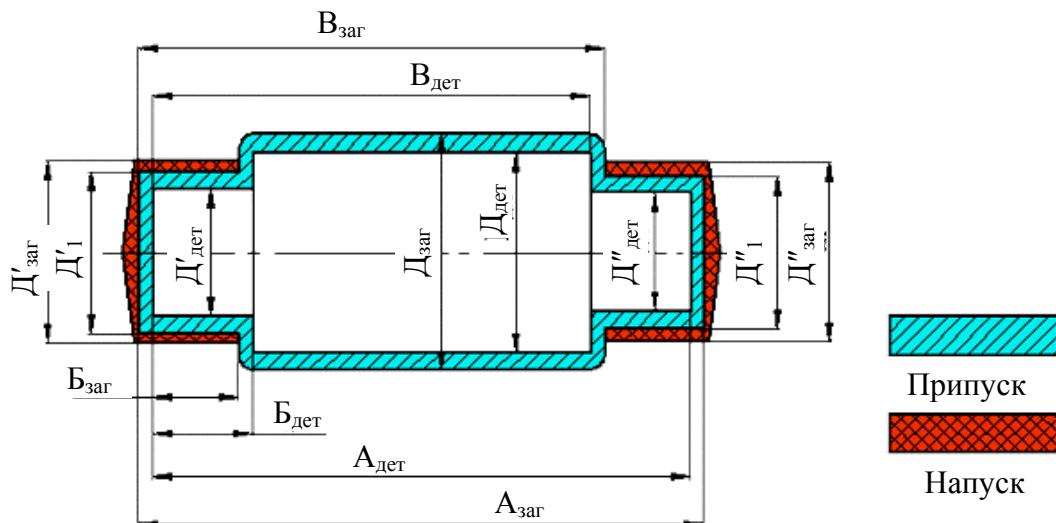
Рис. 1.2. Припуски, напуски на размеры вала:  $A_{заг}$ ,  $B_{заг}$ ,  $B_{дет}$ ,  $D'_{заг}$ ,  $D''_{заг}$  – исходные размеры заготовки;  $A_{дет}$ ,  $B_{дет}$ ,  $D'_дет$ ,  $D''_дет$  – размеры детали;  $D_1$ ,  $D_2$ ,  $D'_1$ ,  $D''_1$  – операционные размеры заготовки
