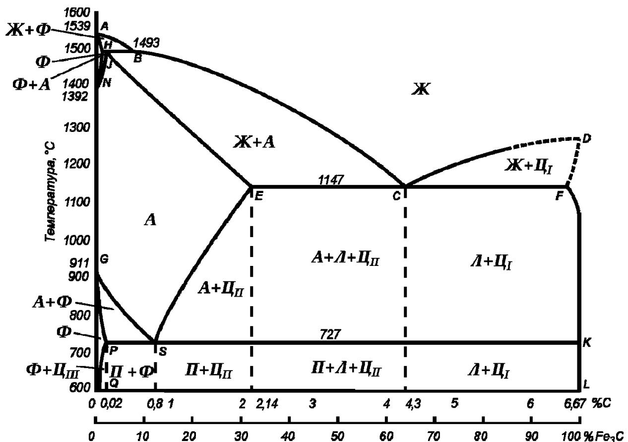
Рис. 2.21. Диаграмма состояния Fe-Fe<sub>3</sub>C
