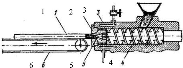
Рис. 9.9. Горизонтальный экструдер: 1 – изделие; 2 – мундштук; 3 – нагреватель; 4 – шнек; 5 – донр (оправка); 6 – транспортер
