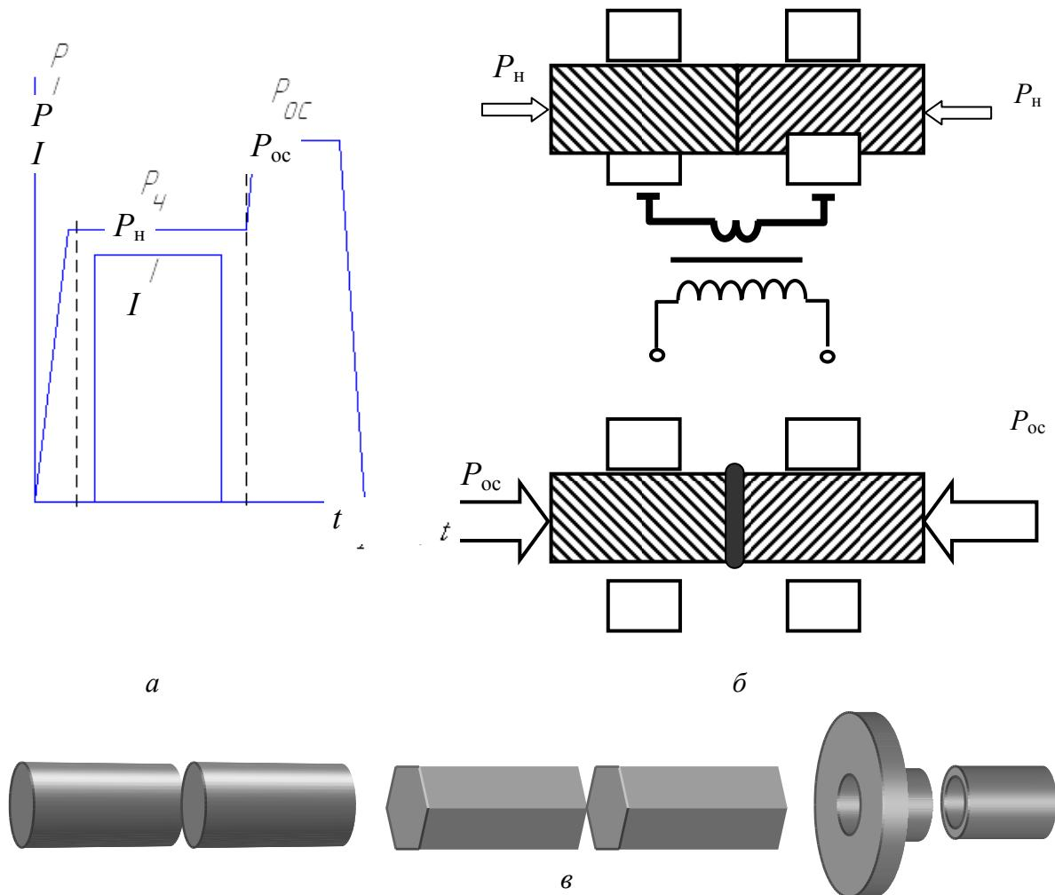
Рис. 7.23. Стыковая контактная сварка сопротивлением:
