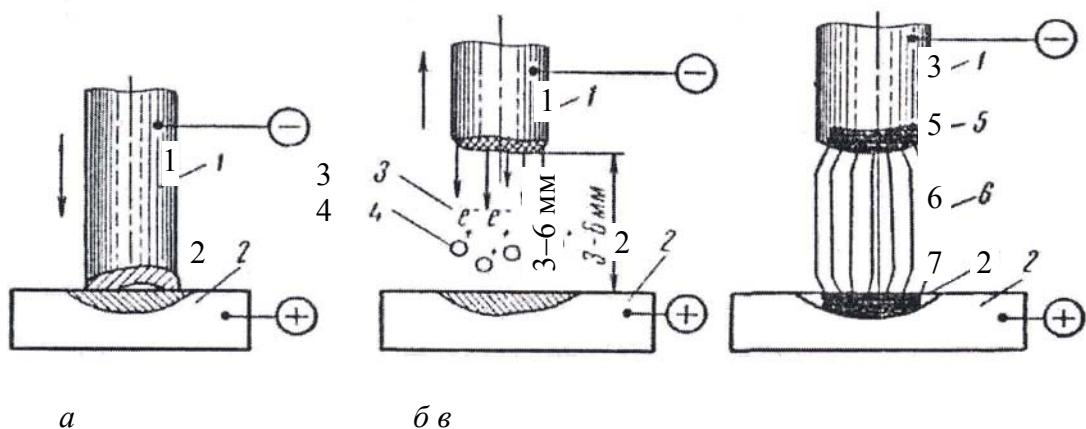
Рис. 7.3. Зажигание электрической дуги: *a* – короткое замыкание; *б, в* – этапы формирования стабильной дуги
