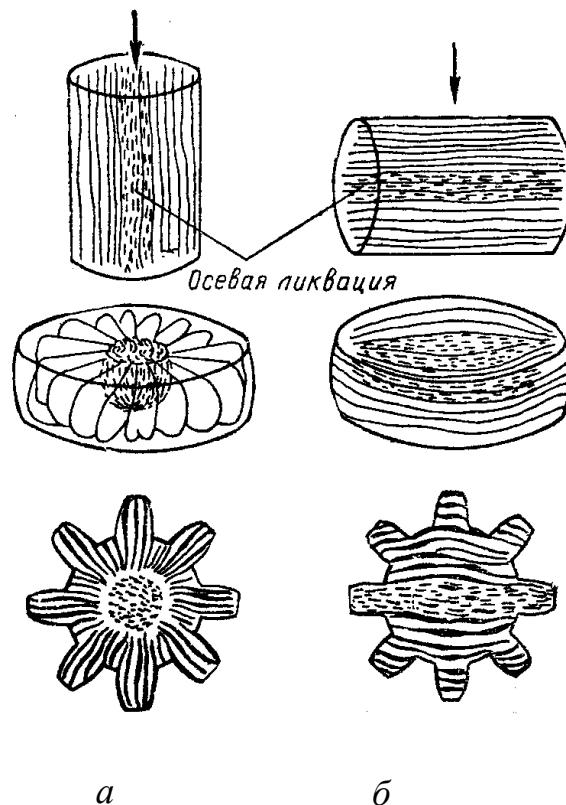
Рис. 6.12. Способы ковки и макроструктура кованых шестерен:
