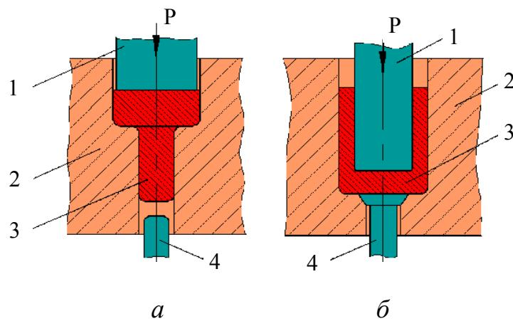
Рис. 6.48. Схемы штамповки в штампах для прямого (*а*) и обратного (*б*) выдавливания:
