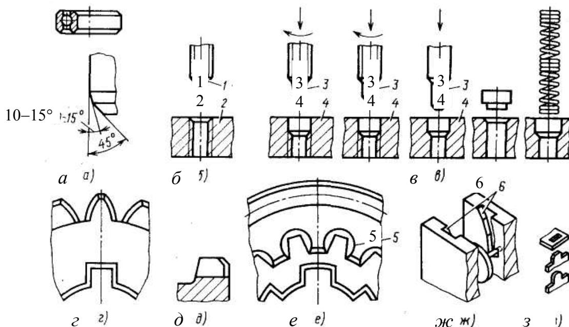
Рис. 13.5. Технологичные конструкции заходных поверхностей соединяемых деталей
