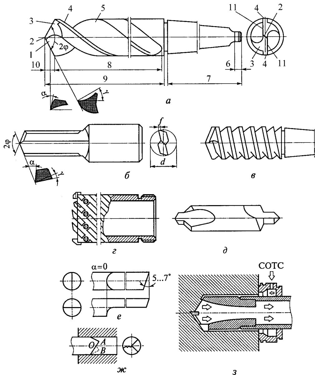
Рис. 10.23. Сверла: *a* – спиральное: 1 – передняя поверхность; 2 – поперечная кромка; 3 – главная задняя поверхность; 4 – ленточка; 5 – винтовая канавка; 6 – лапка; 7 – хвостовик; 8 – направляющая часть; 9 – рабочая часть; 10 – режущая часть; 11 – главная режущая кромка; *b* – первое; *c* – шнековое; *г* – кольцевое; *д* – центровочное; *е* – пушечное; *ж* – ружейное; *з* – эжекторное; *д* – диаметр сверла; *f* – ленточка;  $\alpha$ ,  $\gamma$ ,  $\phi$  – углы резания
