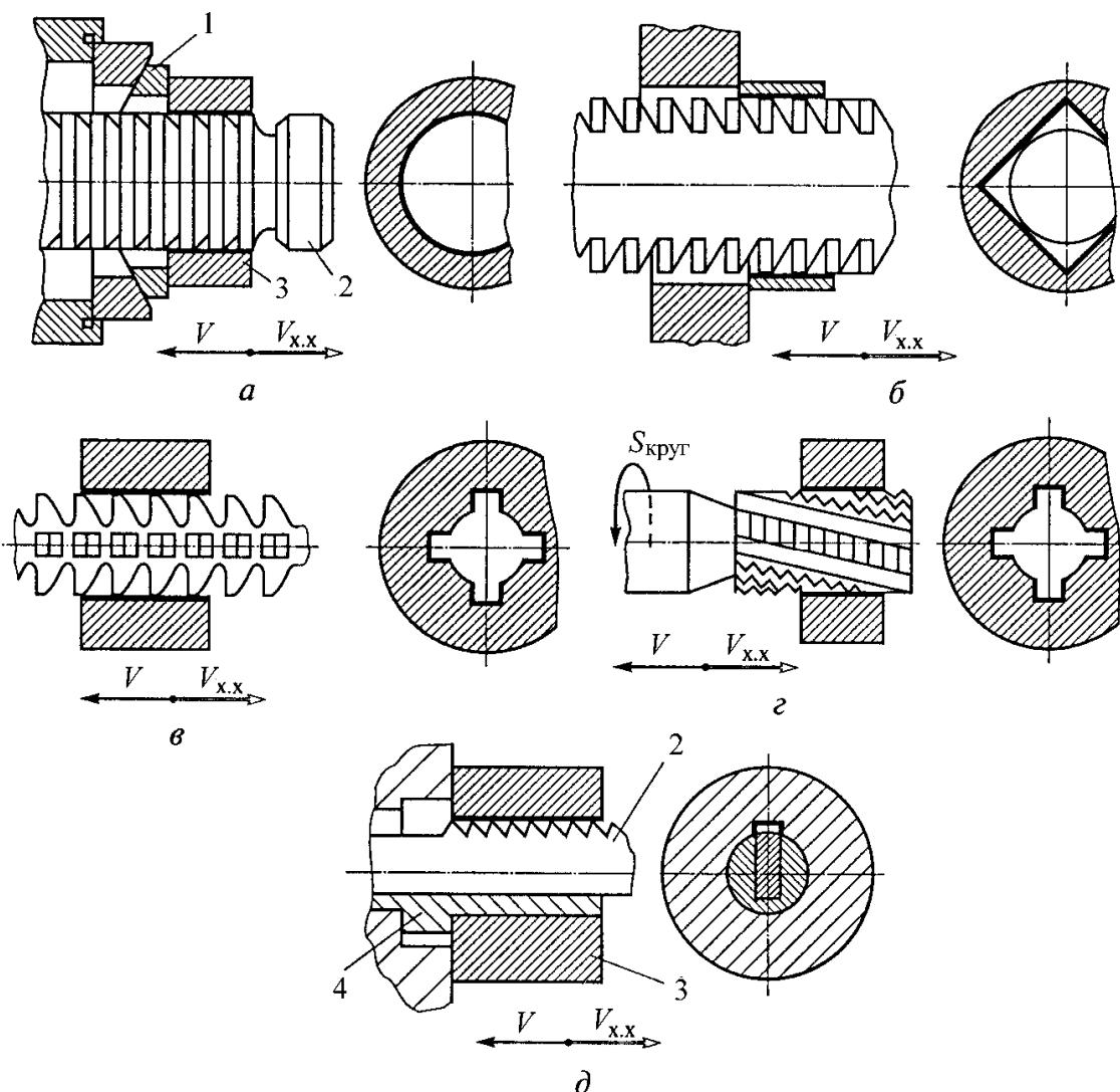
Рис. 10.35. Схемы протягивания отверстий: *а* – на сферической опоре; *б* – многогранных; *в* – прямых шлицевых; *г* – винтовых шлицевых; *д* – шпоночных пазов; 1 – сферическая опора; 2 – протяжка; 3 – заготовка; 4 – направляющая втулка
