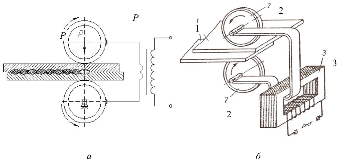
Рис. 7.26. Шовная контактная сварка:
