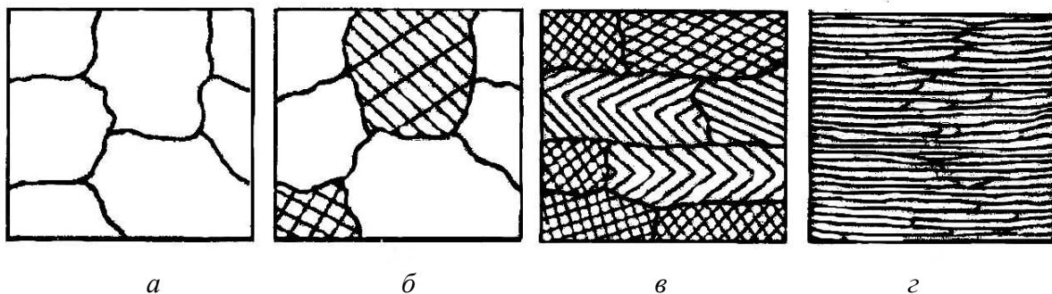
Рис. 6.7. Изменение микроструктуры поликристаллического металла при деформации: *а* – исходное состояние ( $\epsilon = 0 \%$ ); *б* –  $\epsilon = 1 \%$ ; *в* –  $\epsilon = 40 \%$ ; *г* –  $\epsilon = 80\text{--}90 \%$
