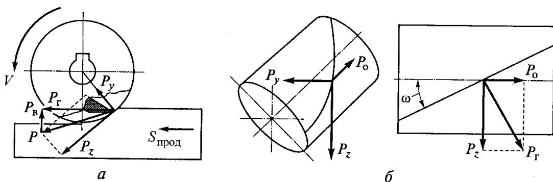
Рис. 10.45. Силы резания при фрезеровании: *а* – разложение силы резания  $P$  на составляющие; *б* – осевая сила  $P_o$ ;  $P_x$ ,  $P_y$ ,  $P_z$  – составляющие силы резания на координатные оси;  $P_v$ ,  $P_g$  – соответственно вертикальная и горизонтальная составляющие силы резания;  $\omega$  – угол наклона зуба фрезы
