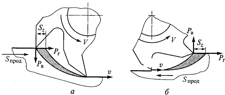
Рис. 10.44. Фрезерование: *а* – попутное; *б* – встречное;  $P_r$  и  $P_b$  – соответственно горизонтальная и вертикальная составляющие силы резания
