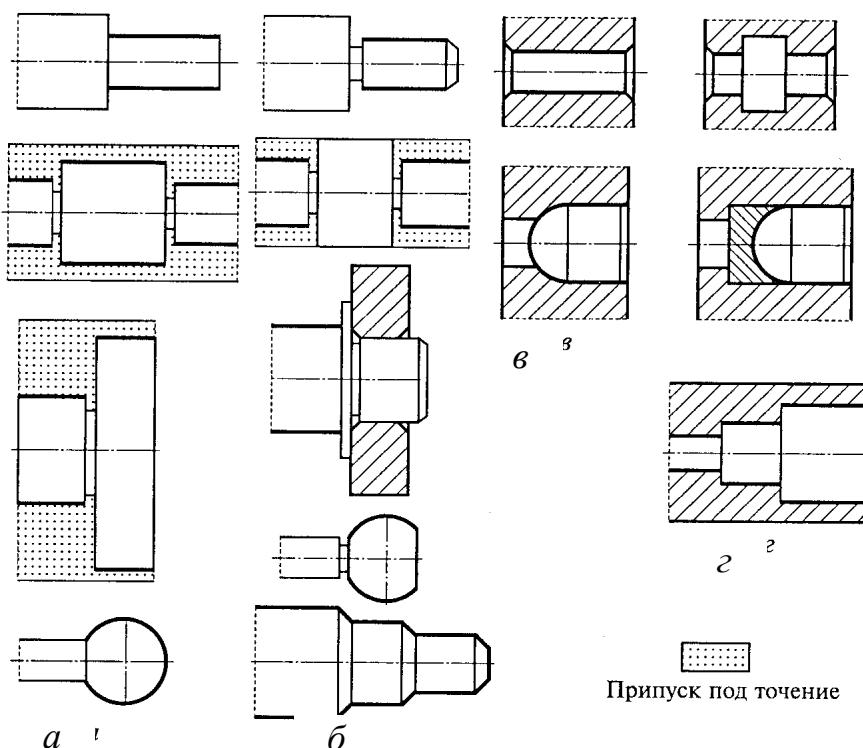
Рис. 10.20. Технологические требования к деталям, обрабатываемым на токарных станках: *а* – нетехнологичные решения при обработке валов; *б* – технологичные решения при обработке валов; *в* – нетехнологичные решения при обработке отверстий; *г* – технологичные решения при обработке отверстий
