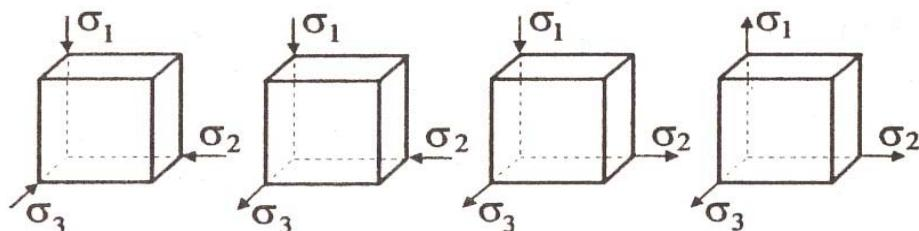
Рис. 6.13. Схемы объемно-напряженного состояния при обработке металлов давлением
