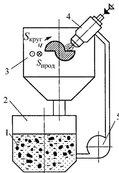
Рис. 10.71. Установка для абразивно-жидкостной обработки:
