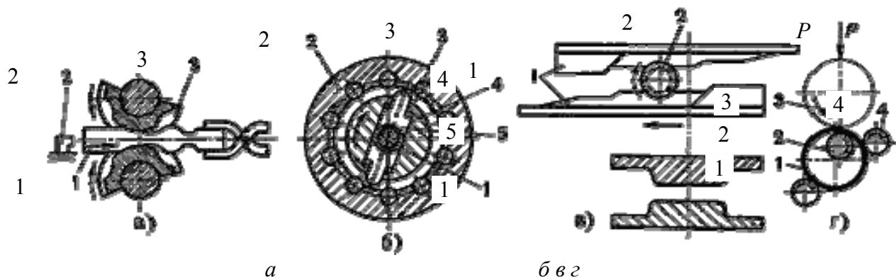
Рис. 6.51. Схемы действия ковочных вальцов (а), ротационно-ковочной машины (б), станов поперечно-клиновой прокатки (в), раскатки (г)
