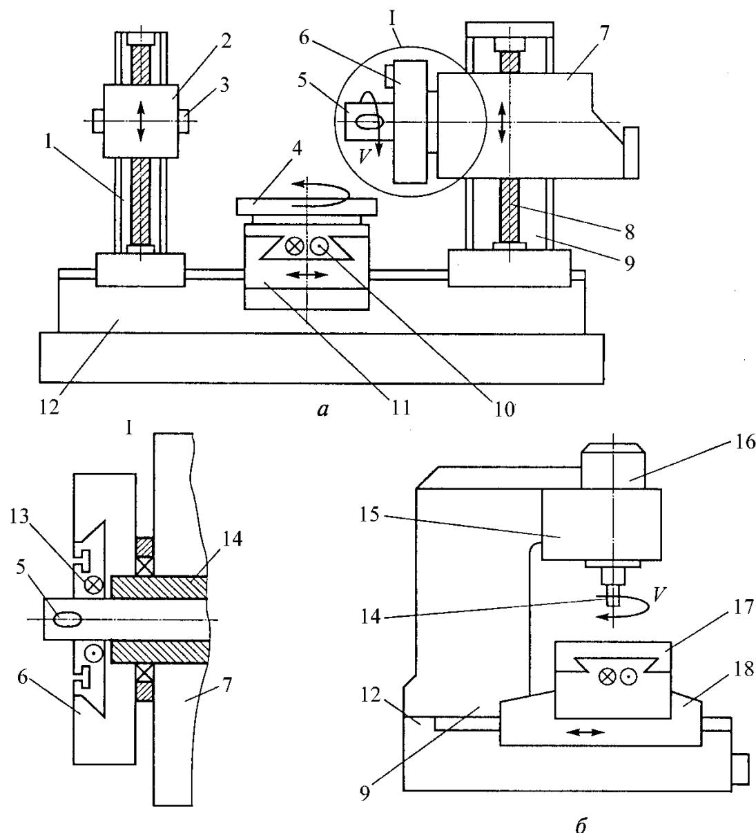
Рис. 10.29. Расточные станки: *а* – горизонтально-расточный станок; *б* – координатно-расточный станок; 1 – задняя стойка; 2 – подшипник; 3 – посадочное окно; 4 – поворотный стол; 5 – расточный шпиндель; 6 – планшайба; 7 – шпиндельная бабка; 8 – винтовой механизм; 9 – передняя стойка; 10 – поперечная каретка; 11 – продольные салазки; 12 – станина; 13 – радиальный суппорт; 14 – шпиндель; 15 – расточная головка; 16 – коробка скоростей; 17 – стол; 18 – поперечные салазки; *V* – движение резания
