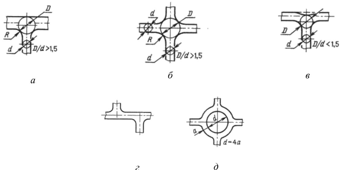
Рис. 5.25. Устранение местного скопления металла в стенках отливки:
