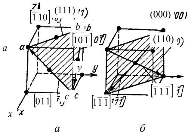
Рис. 2.5. Обозначение кристаллографических плоскостей куба и различных кристаллографических направлений: *a* – в ГЦК-решетке; *б* – в ОЦК-решетке
