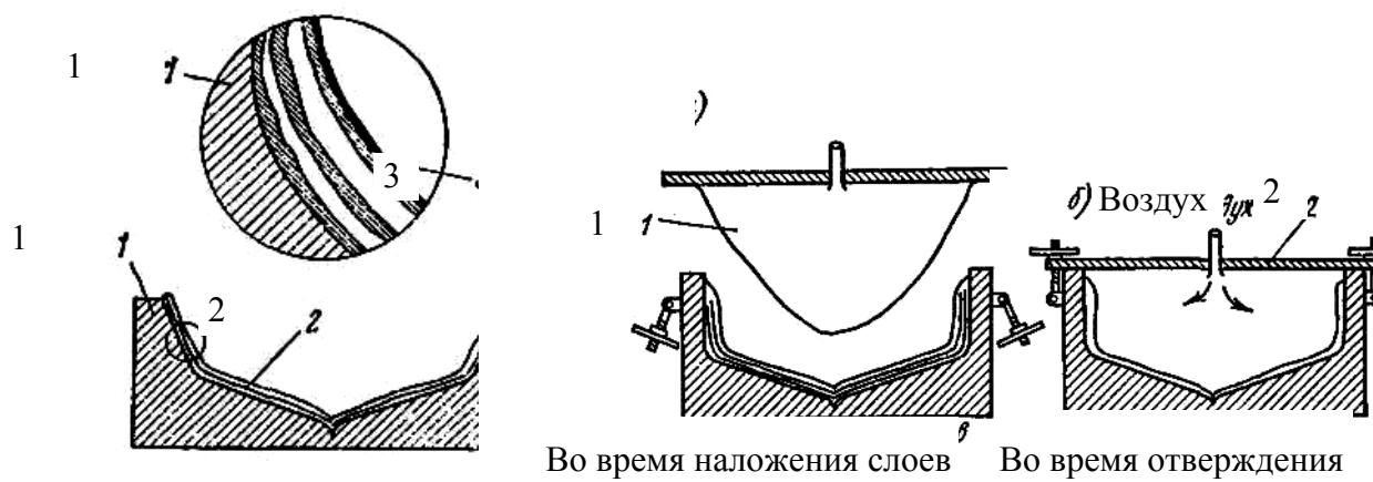
Рис. 9.17. Схема контактного формования крупногабаритных изделий: 1 – форма; 2 – слой жидкого связующего; 3 – целлофановый лист
