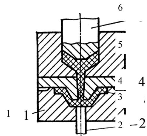
Рис. 9.14. Схема литьевого прессования: 1 – неподвижная часть формы; 2 – выталкиватель; 3 – изделие; 4 – подвижная часть формы; 5 – загрузочная камера; 6 – пуансон
