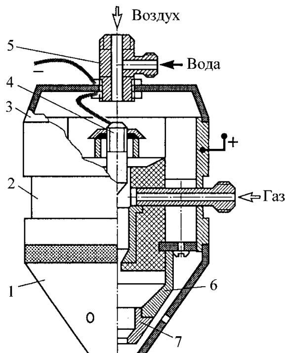
Рис. 11.10. Плазменная горелка с дросселирующим воздушно-водяным охлаждением:
