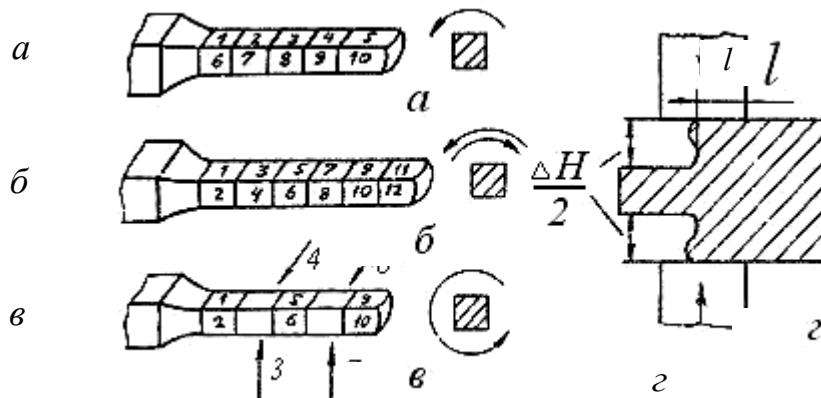
Рис. 6.31. Способы выполнения протяжки: *а–в* – последовательность выполнения; *г* – величина подачи при протяжке
