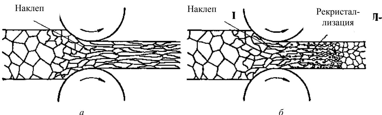
Рис. 6.9. Схемы изменения микроструктуры металла при деформации (прокатке):
