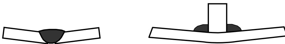
Рис. 7.36. Коробление при сварке
