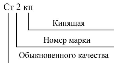
Рис. 2.23. Марка конструкционной стали обыкновенного качества
