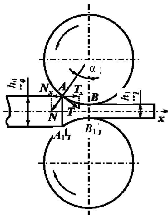
Рис. 6.16. Определение угла захвата заготовки прокатными валками
