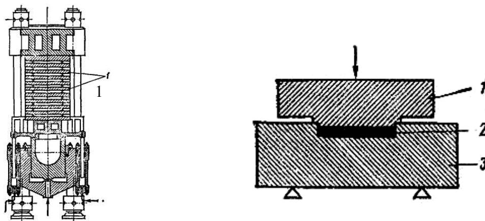
Рис. 9.12. Схема гидравлического этажного пресса: 1 – стальные плиты
