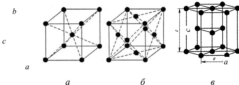
Рис. 2.2. Кристаллические решетки металлов: *а* – объемно-центрированная кубическая (ОЦК); *б* – гранецентрированная кубическая (ГЦК); *в* – гексагональная плотноупакованная (ГПУ)
