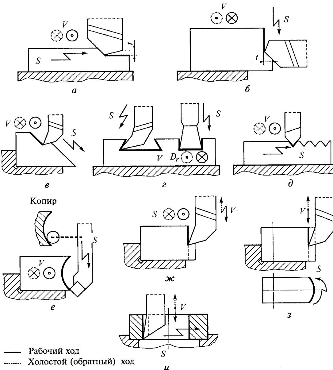
Рис. 10.52. Виды строгальных и долбежных работ: *а–в* – строгание плоских, горизонтальных и наклонных поверхностей; *г, д* – строгание пазов и рифлений; *е* – строгание фасонной поверхности по копиру; *жс* – долбление плоской поверхности; *з* – долбление фасонной поверхности с круговой подачей; *и* – долбление шпоночного паза; *V* – движение резания; *t* – глубина резания
