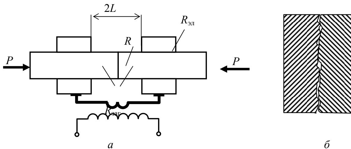
Рис. 4.1. Стыковая электроконтактная сварка сопротивлением:
