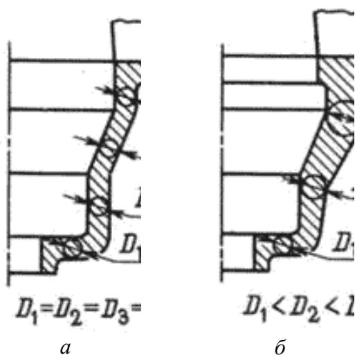
Рис. 5.26. Конструкции литых деталей, обеспечивающих одновременное (а)
