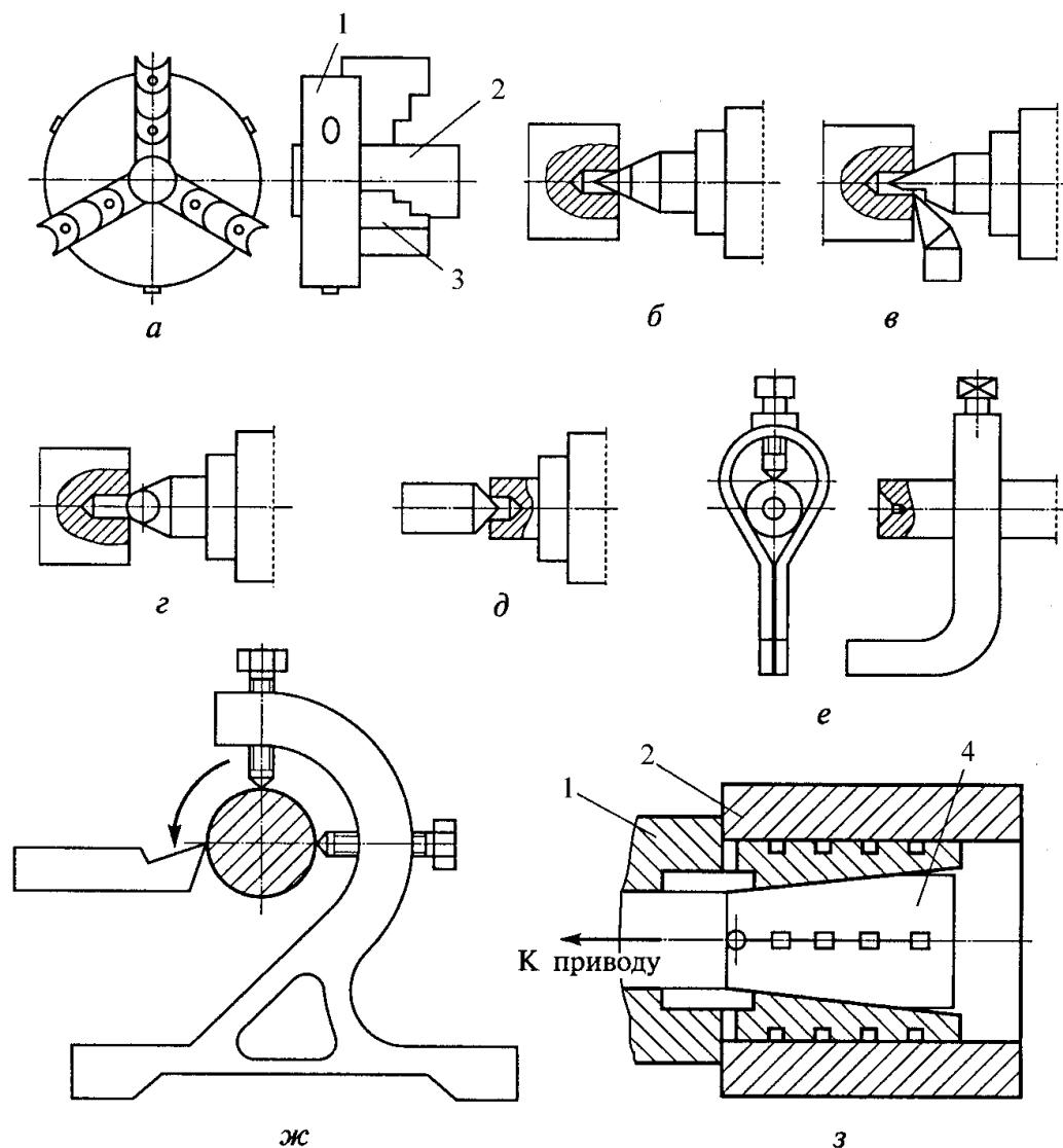
Рис. 10.12. Рабочие приспособления, применяемые в токарных станках: *а* – трехкулачковый патрон; *б* – неподвижный центр; *в* – срезанный центр; *г* – шариковый центр; *д* – обратный центр; *е* – хомутик; *жс* – неподвижный люнет; *з* – цанговый патрон; 1 – корпус; 2 – заготовка; 3 – кулачки; 4 – конус
