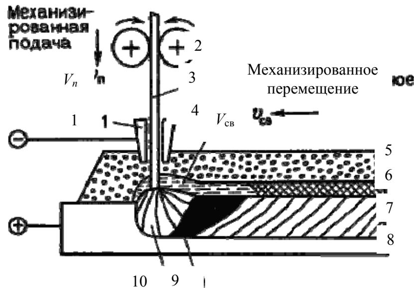
Рис. 7.11. Схема автоматической дуговой сварки под флюсом
