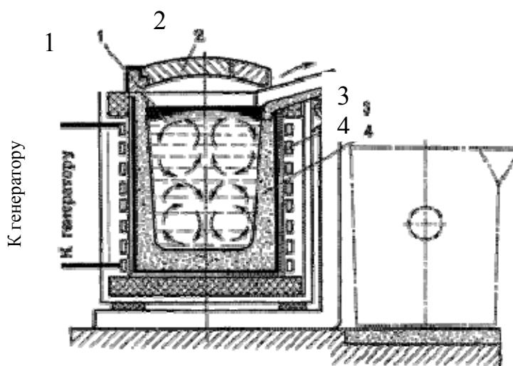
Рис. 3.4. Схема индукционной тигельной печи
