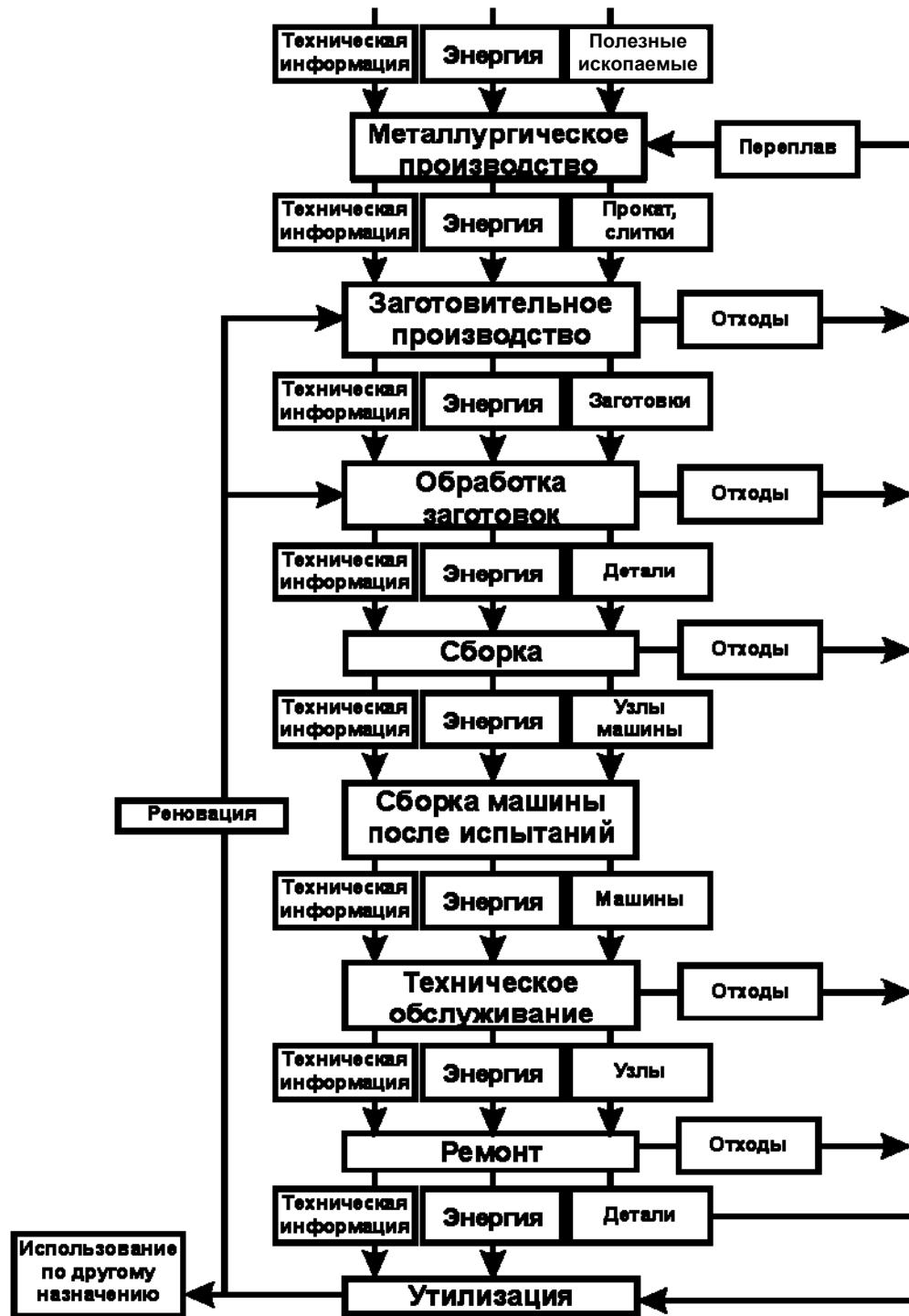
Рис. 1.1. Основные этапы изготовления и обслуживания изделий машиностроительного производства
