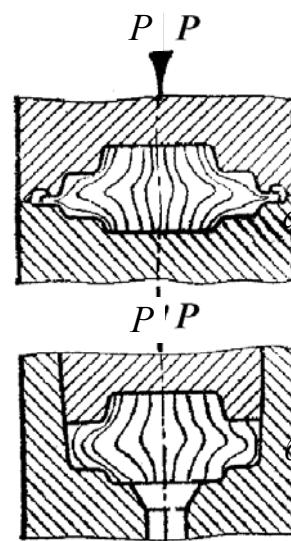
Рис. 6.10. Схемы процессов и расположения волокон в поковках при штамповке:
