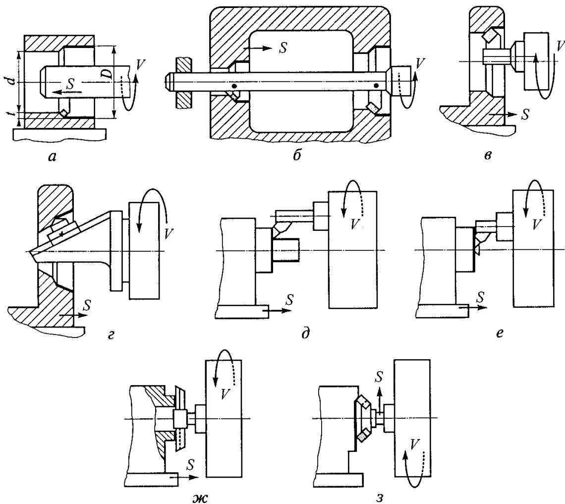
Рис. 10.26. Схемы обработки поверхностей на расточных станках: *а* – растачивание консольным закреплением резца; *б* – растачивание борштангой; *в*, *г* – растачивание резцом, закрепленным в планшайбе; *д* – обтачивание; *е*, *жс* – подрезание торцов; *з* – обработка плоскостей; *д*, *D* – диаметры заготовки и изделия; *t* – глубина резания
