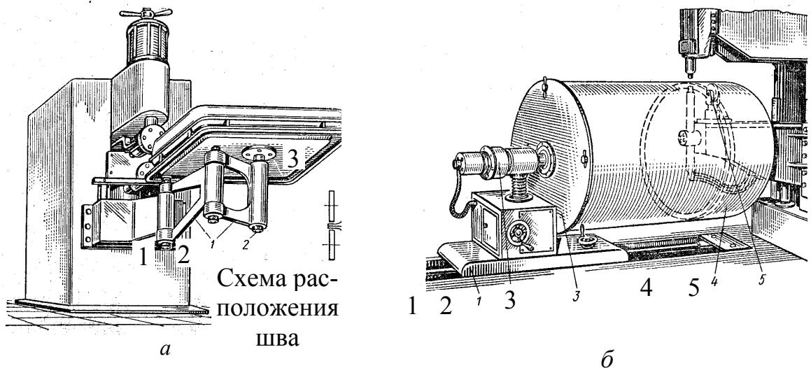
Рис. 8.4. Контактная сварка: а – шовная (бензобака); б – точечная (обечайки);
