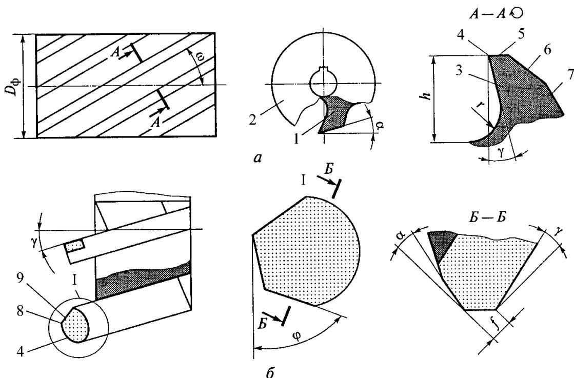
Рис. 10.46. Углы заточки фрез: *а* – цилиндрических; *б* – торцевых; 1 – режущий зуб; 2 – корпус фрезы; 3 – передняя поверхность; 4 – главная режущая кромка; 5 – ленточка; 6 – задняя поверхность; 7 – спинка зуба; 8 – переходная кромка; 9 – вспомогательная кромка; *f* – фаска; *h* – высота зуба; *r* – радиус впадины между зубьями;  $\alpha$ ,  $\gamma$ ,  $\phi$  – углы резания;  $D_\Phi$  – диаметр фрезы;  $\omega$  – угол наклона зуба фрезы
