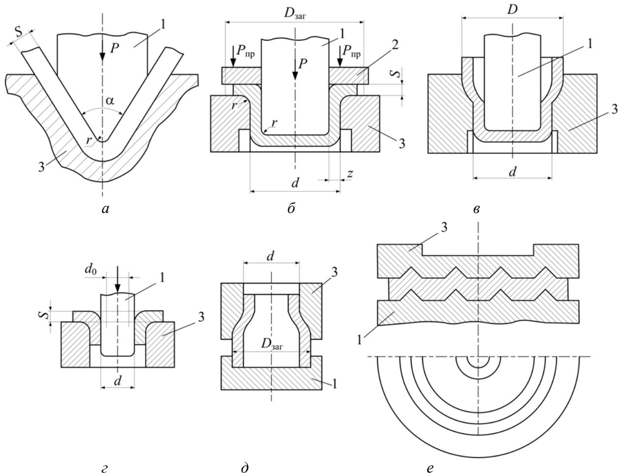
Рис. 6.54. Формоизменяющие операции листовой штамповки: *а* – гибка; *б, в* – вытяжка; *г* – отбортовка; *д* – обжим; *е* – формовка; *1* – пuhanсон; *2* – прижим; *3* – матрица
