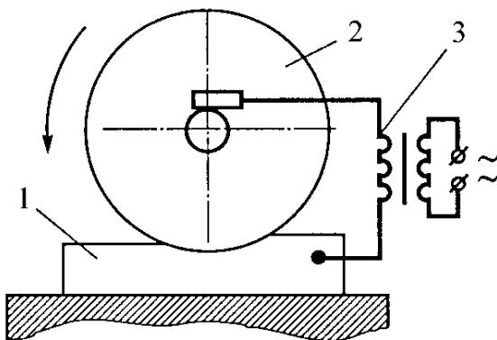
Рис. 11.4. Электроконтактная обработка:
