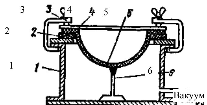
Рис. 9.16. Схема штамповки свободной вытяжкой: 1 – вакуум-камера; 2, 4 – протяжное и прижимное кольца; 3 – зажимы; 5 – заготовка; 6 – указатель
