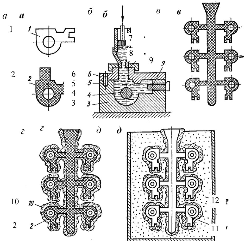
Рис. 5.18. Схема литья по выплавляемым моделям: *а* – конфигурация детали и модели; 1 – деталь; 2 – модель; *б* – изготовление модели в пресс-форме; *в* – сборка моделей в блок; *г* – образование оболочки на моделях; *д* – подготовка формы к заливке; 3, 6 – нижняя, верхняя матрицы; 4, 9 – металлические стержни; 5 – направляющий штырь; 7 – поршень; 8 – модельная масса; 10 – оболочка; 11 – полость формы; 12 – накопитель
