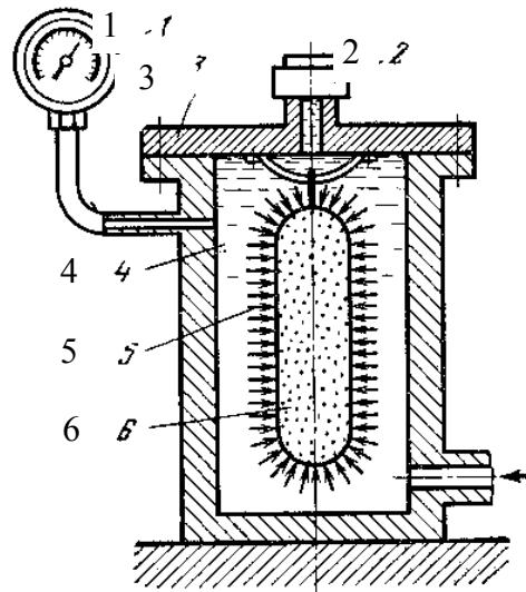
Рис. 9.5. Схема установки гидростатического формования:
