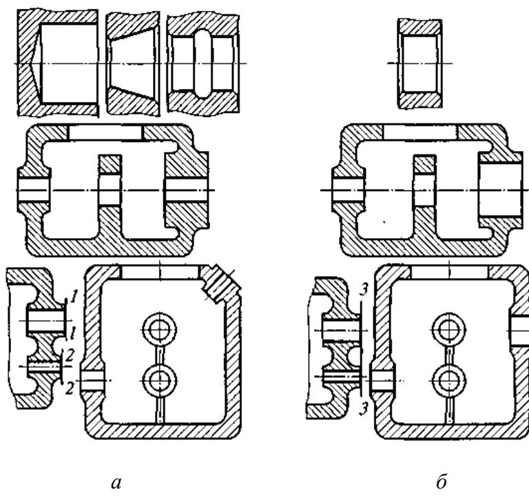
Рис. 10.30. Технологические требования к деталям, обрабатываемым на расточных станках: *а* – нетехнологичные конструкции; *б* – технологичные конструкции;
