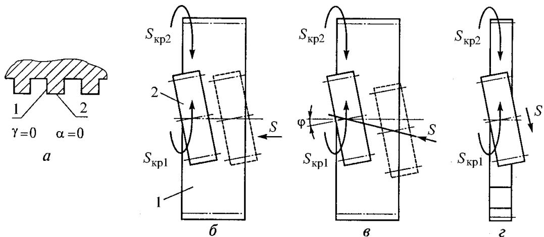
Рис. 10.62. Зубошвингование: *а* – зуб шевера; *1* – главная режущая кромка; *2* – вспомогательная режущая кромка; *б* – швингование с продольной подачей; *1* – заготовка; *2* – шевер; *в* – швингование с диагональной подачей; *г* – швингование с поперечной подачей
