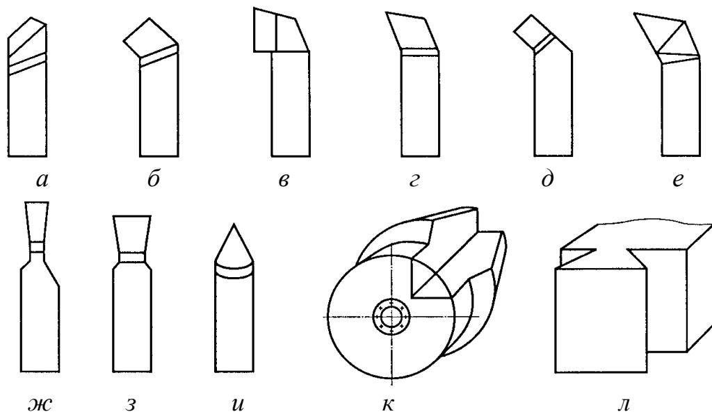
Рис. 10.11. Токарные резцы: *а* – проходной прямой; *б* – проходной отогнутый; *в* – проходной упорный отогнутый; *г* – подрезной; *д, е* – расточные для сквозных и глухих отверстий соответственно; *жс* – отрезной; *з* – канавочный; *и* – резьбовой; *к* – круглый фасонный; *л* – призматический фасонный
