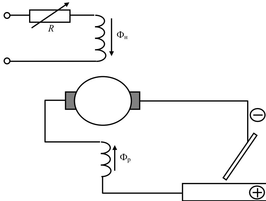
Рис. 7.9. Схема сварочного генератора с независимым возбуждением и последовательной размагничивающей обмоткой
