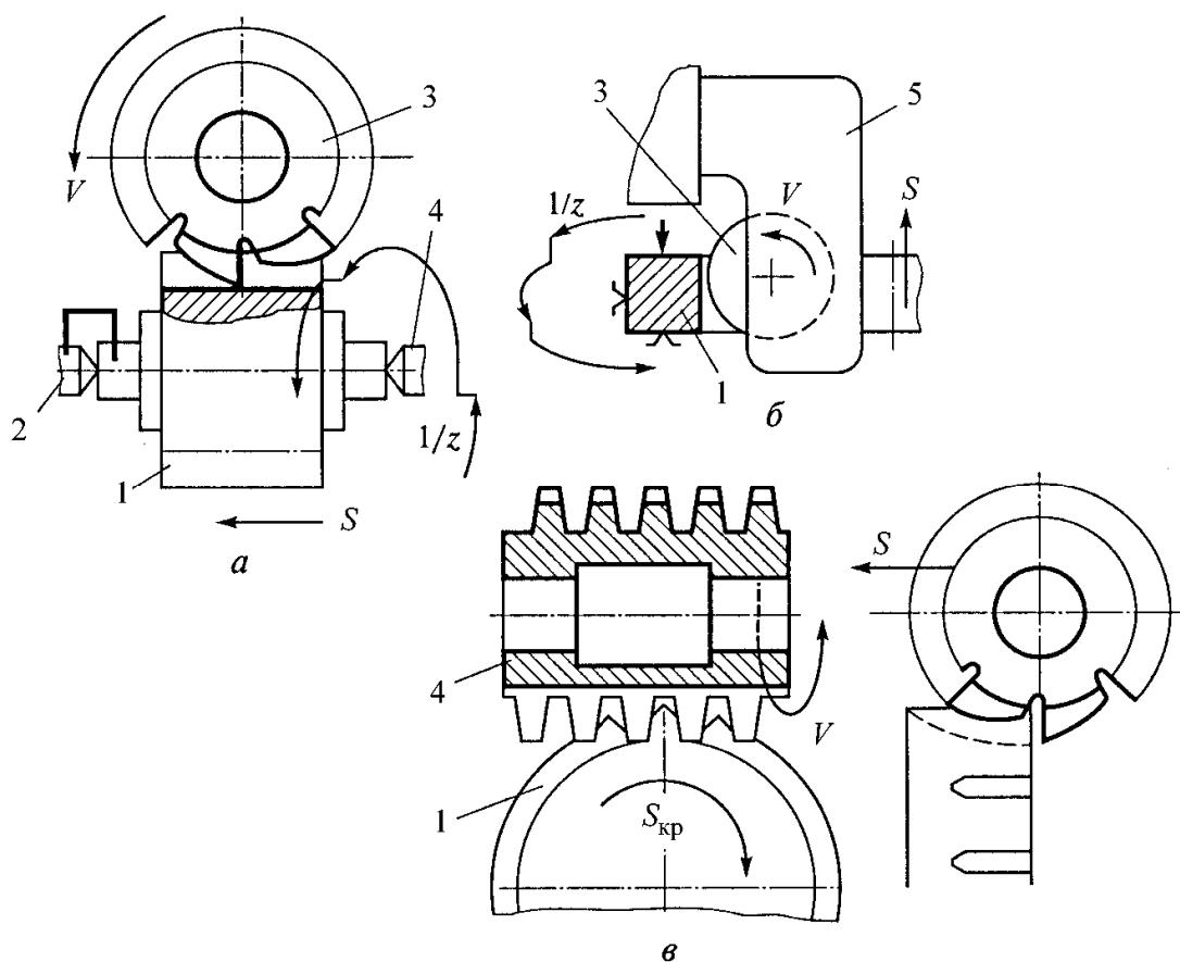
Рис. 10.61. Зубофрезерование: *а* – наружного венца методом копирования; *б* – внутреннего венца методом копирования; *в* – наружного венца методом обката; 1 – заготовка; 2, 4 – центры; 3 – червячная фреза; 5 – накладная головка;  $1/z$  – делительный поворот
