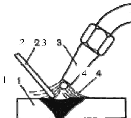
Рис. 7.15. Схема газовой сварки
