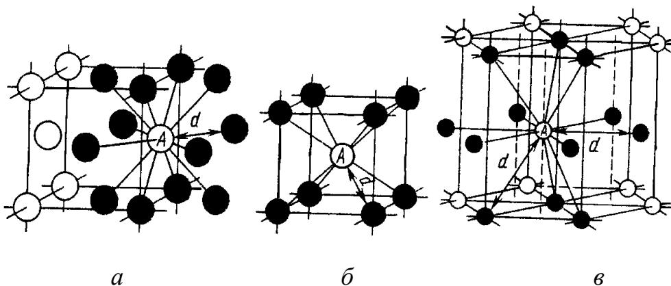
Рис. 2.3. Число атомов, находящихся на наименьшем расстоянии от данного атома *A* в разных кристаллических решетках: *а* – ГЦК; *б* – ОЦК; *в* – ГПУ
