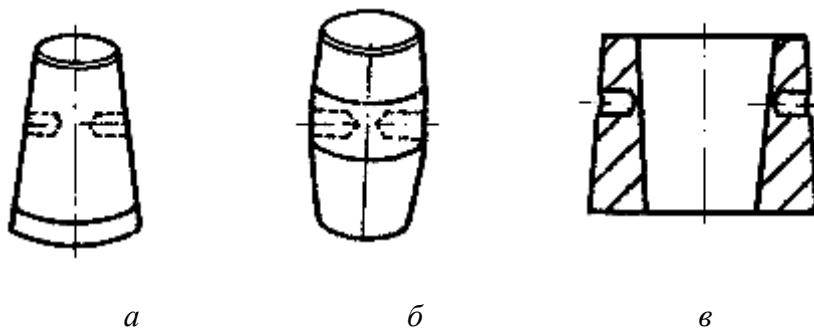
Рис. 6.38. Прошивни: а, б – сплошные; в – полый
