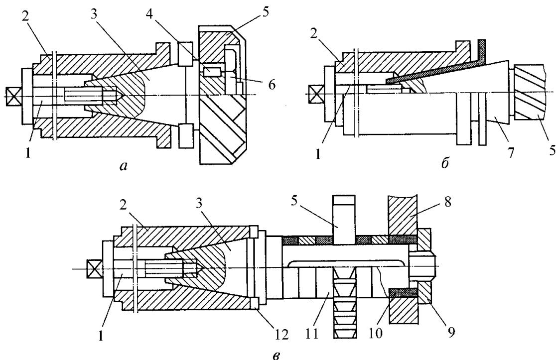
Рис. 10.49. Оправки к фрезерным станкам: *а* – для торцевых фрез; *б* – для концевых фрез; *в* – для цилиндрических фрез; 1 – винт; 2 – шпиндель; 3 – оправка; 4 – шпонка; 5 – фреза; 6, 9 – гайки; 7 – коническая втулка; 8 – серьга; 10 – подшипник; 11 – цилиндрическая втулка; 12 – сухари
