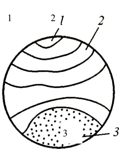
Рис. 2.19. Излом усталостного разрушения: 1 – очаг зарождения трещины; 2 – зона усталости; 3 – зона долома
