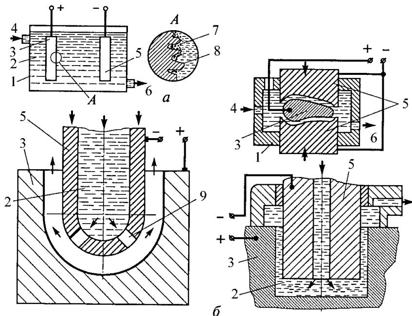
Рис. 11.5. Электрохимическая обработка: *а* – полирование; *б* – размерная обработка; 1 – ванна; 2 – электролит; 3 – заготовка; 4 – подача электролита; 5 – катод; 6 – слив электролита; 7 – продукты растворения; 8 – микронеровности; 9 – отверстие
