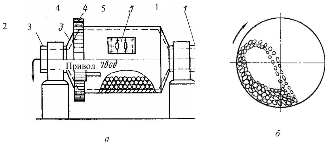
Рис. 9.3. Барабанная шаровая мельница: *а* – схема устройства; *б* – схема перемещения размольных тел и измельчаемого материала
