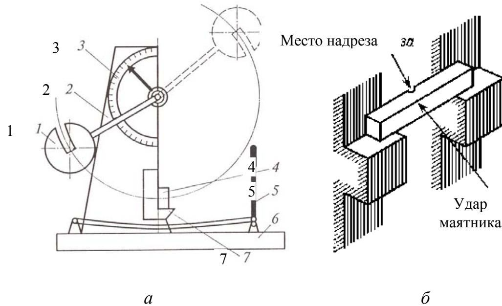
Рис. 2.17. Схема испытаний на ударную вязкость: *a* – маятниковый копер: 1 – нож; 2 – стойка; 3 – шкала; 4 – образец; 5 – ручной тормоз; 6 – основание; 7 – опоры образца; *b* – испытание на ударный изгиб *U*-образного образца
