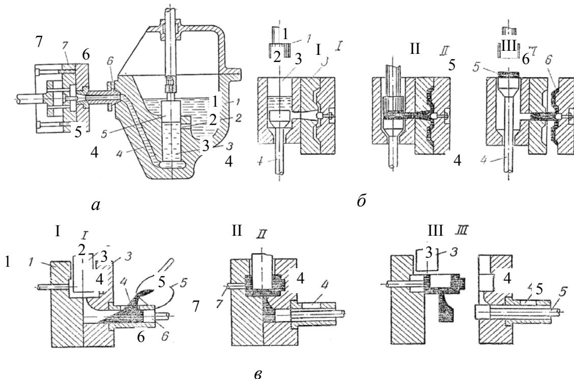
Рис. 5.21. Машины для литья под давлением поршневого действия: *a* – с горячей камерой сжатия; *б* – с холодной камерой сжатия; *в* – с горизонтальной камерой сжатия
