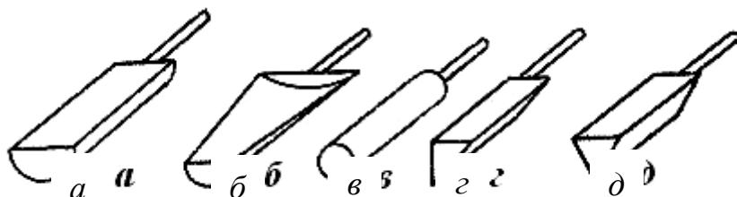
Рис. 6.36. Инструмент: *a–в* – раскатки; *г, д* – пережимки
