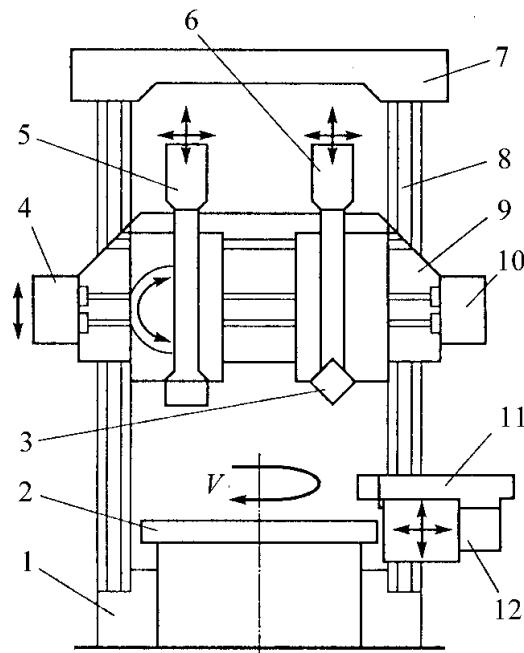
Рис. 10.16. Токарно-карусельный полуавтомат: 1 – станина; 2 – карусель; 3 – револьверная головка; 4, 10, 12 – коробки подач; 5 – верхний суппорт; 6 – револьверный суппорт; 7 – поперечина; 8 – стойка; 9 – траверса; 11 – боковой суппорт
