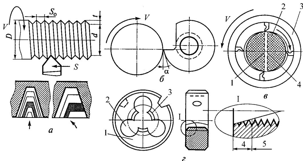
Рис. 10.59. Нарезание наружной резьбы: *а* – призматическим резцом; *б* – круглым резцом; *в* – резцовая головка; 1 – центр вращения головки; 2 – заготовка; 3 – резцовая головка; 4 – центр вращения заготовки; *г* – плашка: 1 – корпус; 2 – отверстия; 3 – режущие зубья; 4 – режущий участок; 5 – калибрующий участок;  $V$  – главное движение;  $S$  – движение подачи;  $S_o$  – подача на оборот;  $D$ ,  $d$  – диаметры резьбы;  $t$  – полная глубина резания;  $\alpha$  – главный задний угол
