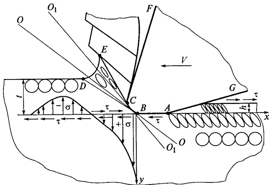
Рис. 10.6. Схема процесса резания:  $V$  – движение резания;  $BCF$  – передняя поверхность;  $GAB$  – задняя поверхность;  $BD$  – плоскость скальвания;  $BDEC$  – зона стружкообразования;  $OO$  – плоскость сдвига;  $O_1O_1$  – направление осей деформированных кристаллов;  $h$  – упругое восстановление обработанной поверхности;  $t$  – глубина резания;  $\sigma$ ,  $\tau$  – нормальные и касательные напряжения соответственно
