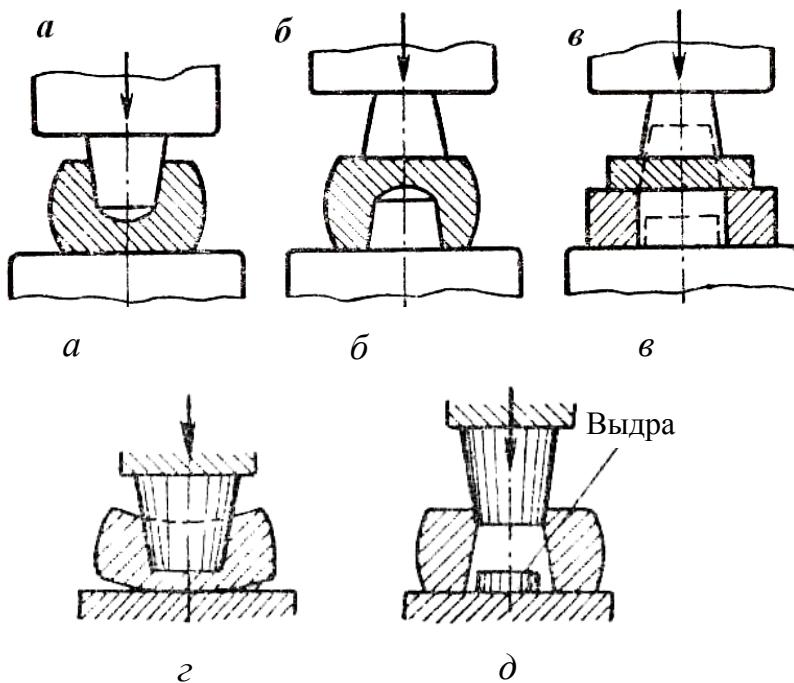
Рис. 6.37. Прошивка отверстий в поковках:
