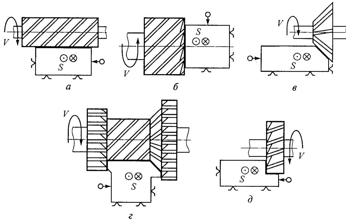
Рис. 10.40. Обработка плоскостей на ГФС: *а* – горизонтальных; *б* – вертикальных; *в* – наклонных; *д* – уступов
