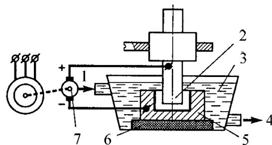
Рис. 11.2. Электроимпульсная обработка: 1 – подача электролита; 2 – инструмент; 3 – диэлектрическая жидкость; 4 – слив электролита; 5 – заготовка; 6 – изолятор; 7 – электромашинный генератор
