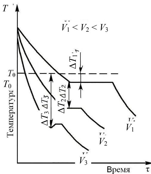
Рис. 5.4. Кривые охлаждения в случае кристаллизации металла при различных степенях переохлаждения
