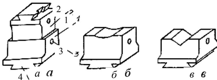
Рис. 6.32. Бойки различной формы: *a* – плоские: 1 – нижний; 2 – верхний; 3 – отверстия для транспортировки; 4 – хвостовик с клином для крепления; *b* – вырезные; *c* – комбинированные
