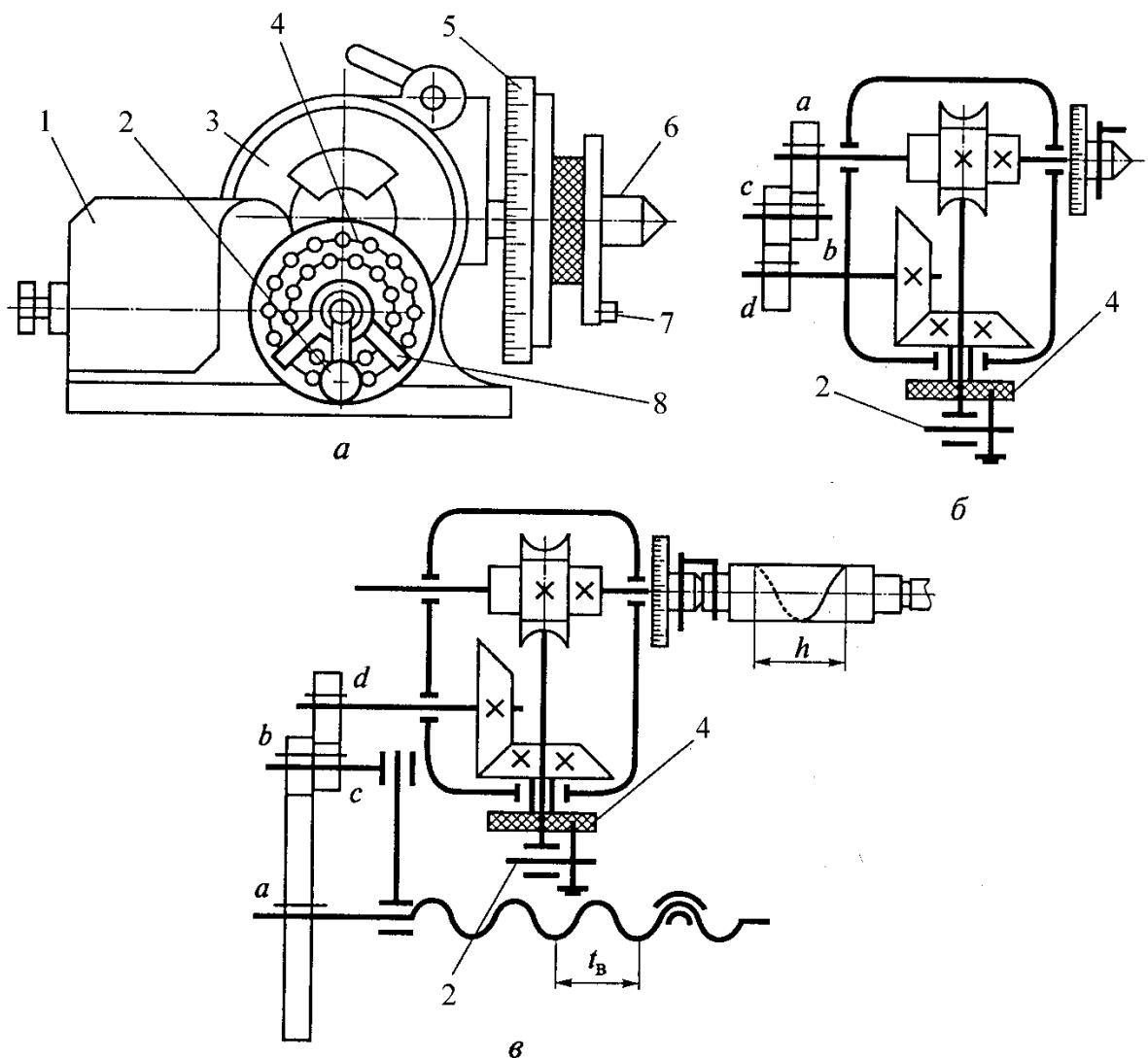
Рис. 10.50. Универсальная механическая делительная головка: *а* – компоновка головки; *б* – дифференциальное деление; *в* – настройка головки для фрезерования винтовых поверхностей; 1 – корпус; 2 – рукоятка; 3 – поворотный барабан; 4 – делительный диск; 5 – лимб; 6 – шпиндель с центром; 7 – поводок; 8 – раздвижной сектор; *a*, *b*, *c*, *d* – сменные колеса; *h* – шаг нарезаемой винтовой канавки; *t<sub>B</sub>* – шаг ходового винта
