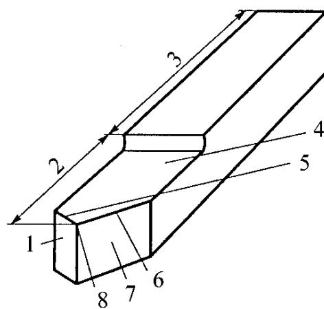
Рис. 10.3. Элементы токарного прямого проходного резца: 1 – вспомогательная задняя поверхность; 2 – головка резца; 3 – тело резца; 4 – передняя поверхность; 5 – 6 – вспомогательная и главная режущие кромки соответственно; 7 – главная задняя поверхность; 8 – вершина резца
