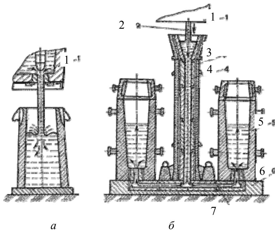
Рис. 3.5. Разливка стали в изложницы: *а* – сверху; *б* – снизу (сифоном)
