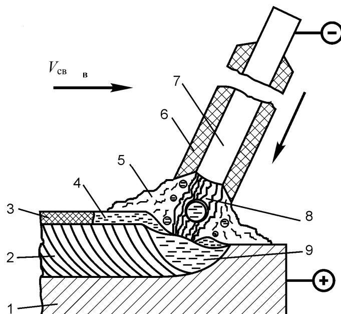
Рис. 7.4. Схема дуговой электросварки металлическим покрытым электродом:
