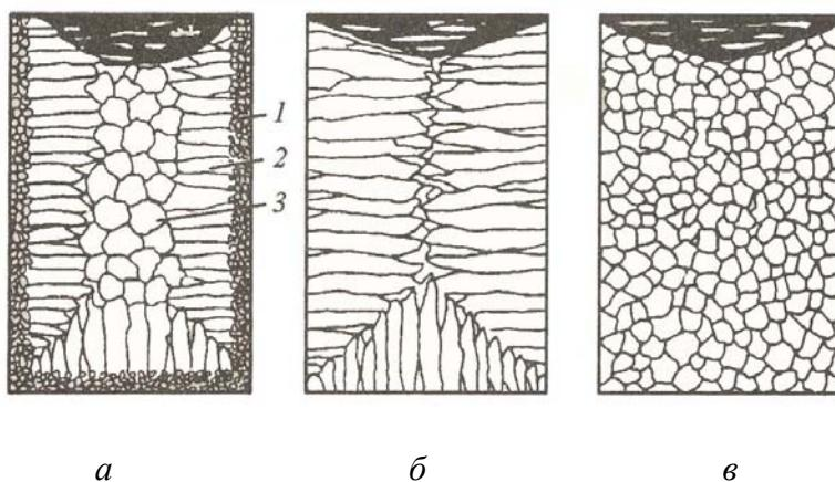
Рис. 5.9. Схемы макроструктур слитков: *а* – типичная;
