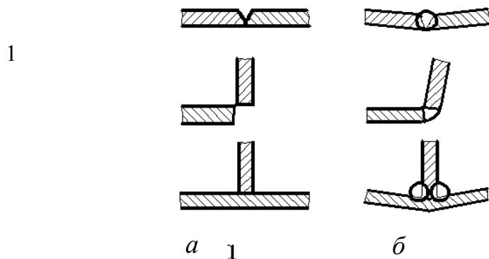
Рис. 7.33. Деформация сварных изделий от поперечной усадки наплавленного металла: *а* – до сварки; *б* – после сварки
