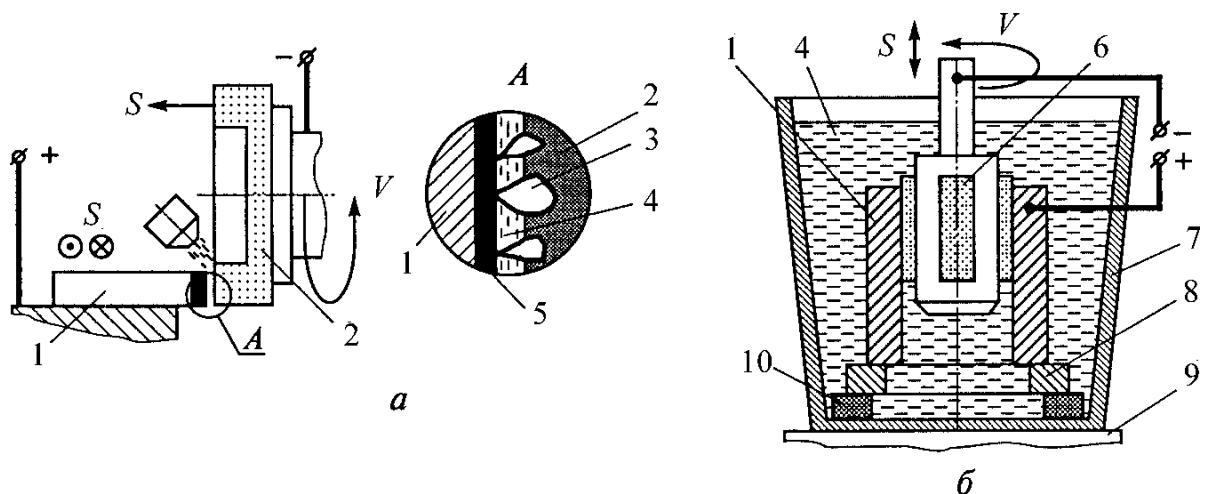
Рис. 11.6. Электроабразивная обработка: *а* – шлифование; *б* – хонингование;
