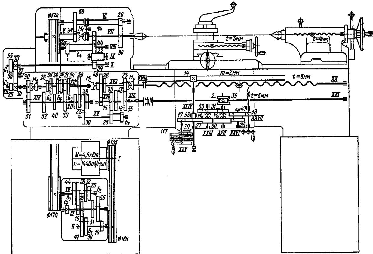
Рис. 10.9. Кинематическая схема токарно-винторезного станка 1А616
