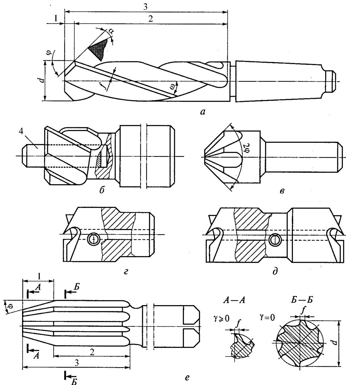
Рис. 10.24. Зенкеры, цековки, зенковки и развертки: *a* – зенкер; *b*, *c* – зенковка; *д* – односторонняя обратная цековка; *д* – двухсторонняя цековка; *e* – развертка; 1 – режущая часть; 2 – калибрующая часть; 3 – рабочая часть; 4 – цапфа; *d* – истинный диаметр развертки; *f* – ширина ленточки;  $\alpha$ ,  $\gamma$ ,  $\omega$  – углы резания
