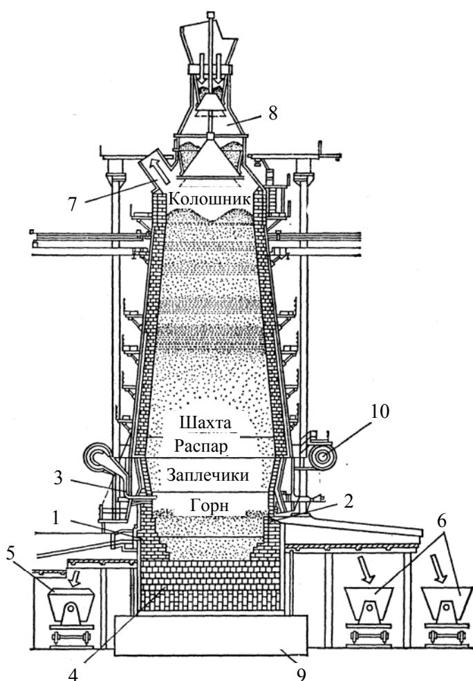
Рис. 3.1. Схема устройства доменной печи: 1 – чугунная летка; 2 – шлаковая летка; 3 – фурмы; 4 – лещадь; 5 – чугуновоз; 6 – шлаковоз; 7 – газоотводящие каналы; 8 – загрузочное устройство; 9 – фундамент; 10 – воздухопривод
