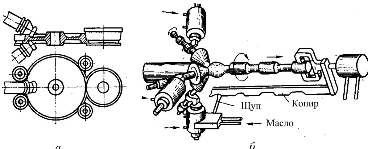
Рис. 6.25. Схемы получения некоторых специальных видов проката
