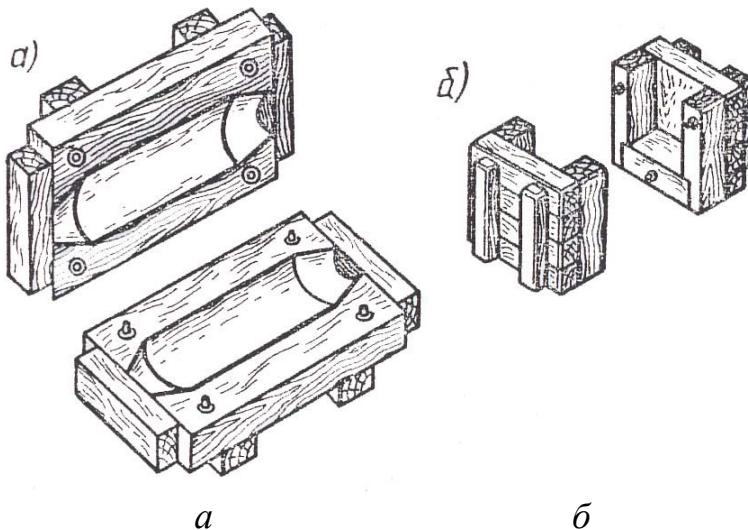
Рис. 5.15. Деревянные стержневые ящики: *а* – для цилиндрического стержня литейной формы чугунного рычага; *б* – для стержня сквозного паза
