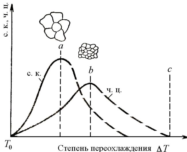
Рис. 5.6. Зависимость параметров кристаллизации от степени переохлаждения:
