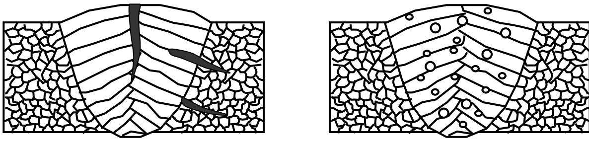
Рис. 7.35. Внутренние дефекты: *а* – трещины; *б* – поры
