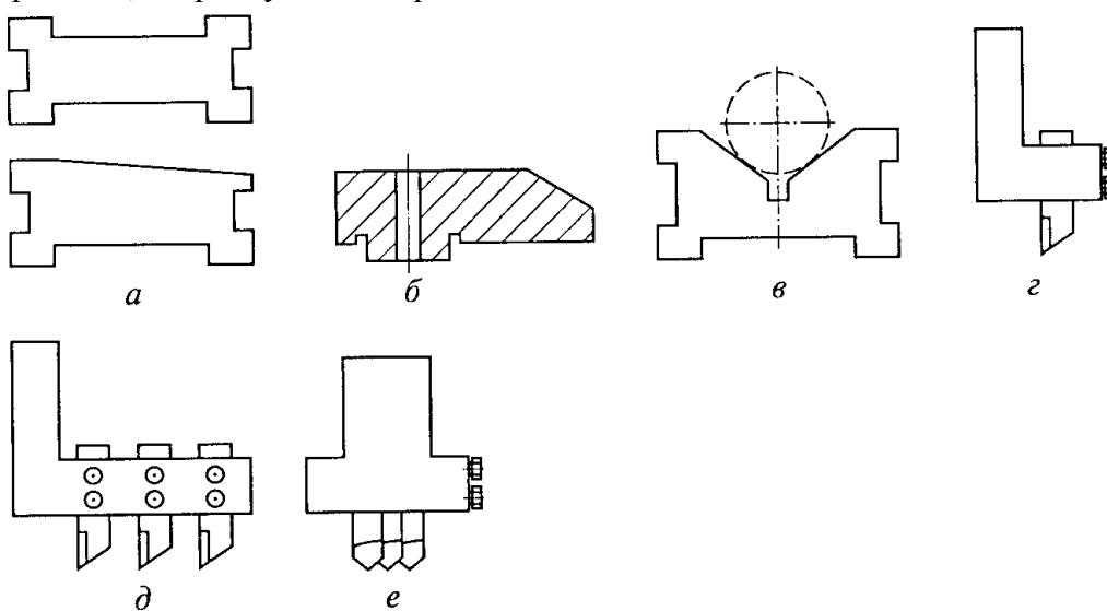
Рис. 10.55. Рабочие приспособления для строгальных и долбежных станков:
