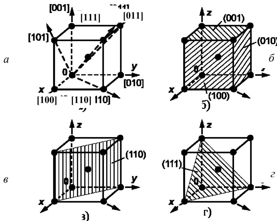
Рис. 2.4. Основные кристаллографические направления (а) и плоскости (б–г)
