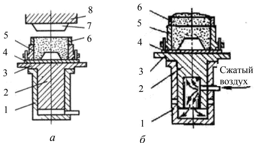
Рис. 5.16. Схемы способов уплотнения литейных форм при машинной формовке: *а* – прессованием; *б* – встряхиванием; 1 – нижняя часть цилиндра; 2 – прессовый (*а*) и встряхивающий (*б*) поршни; 3 – стол; 4 – модельная плита; 5 – опока; 6 – наполнительная рамка; 7 – прессовая колодка; 8 – траверса
