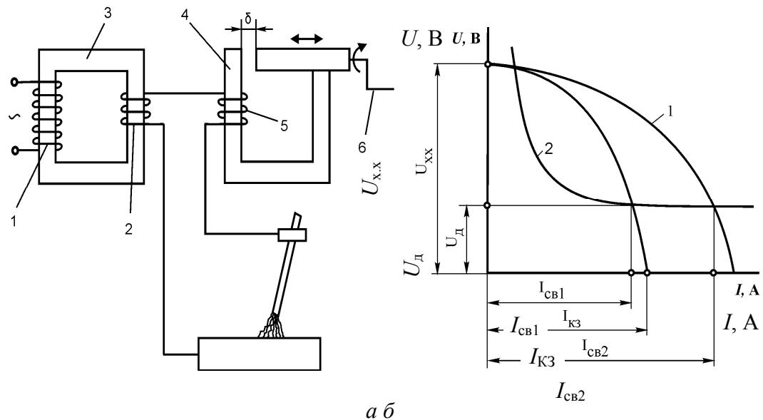
Рис. 7.7. Сварочный трансформатор с отдельной дроссельной катушкой:
