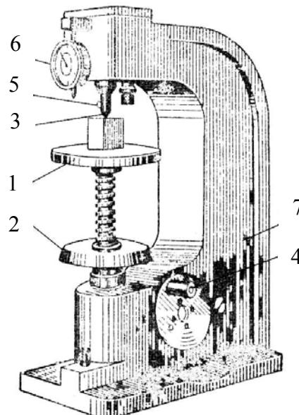
Рис. 2.15. Твердомер ТК для измерения твердости по Роквеллу:
