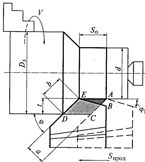
Рис. 10.2. Элементы процесса резания и геометрия срезаемого слоя:  $D_3$  – диаметр заготовки;  $d$  – диаметр обработанной поверхности;  $V$  – движение резания;  $S_{\text{прод}}$  – движение продольной подачи;  $S_0$  – подача на оборот;  $t$  – глубина резания;  $a, b$  – толщина и ширина срезаемого слоя;  $\varphi, \varphi_1$  – углы в плане;  $CDE$  – сечение срезаемого слоя;  $ABE$  – несрезанный гребешок
