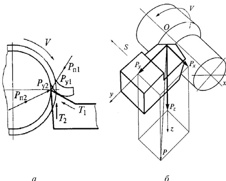
Рис. 10.7. Сила резания: *а* – плоская система сил; *б* – разложение силы резания на составляющие;  $P_{y1}$ ,  $P_{n1}$  – реактивные силы упругой и пластической деформации по передней поверхности;  $P_{y2}$ ,  $P_{n2}$  – реактивные силы упругой и пластической деформации по задней поверхности;  $T_1$ ,  $T_2$  – силы трения;  $P$  – сила резания;  $P_z$ ,  $P_x$ ,  $P_y$  – соответственно главная, осевая и нормальная составляющие силы резания
