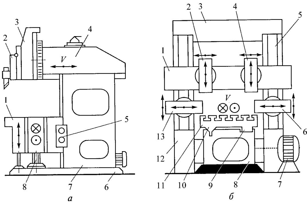
Рис. 10.56. Строгальные станки: *а* – поперечно-строгальный: 1 – стол; 2 – поворотная плита; 3 – суппорт; 4 – ползун; 5 – траверса; 6 – фундаментная плита; 7 – станина; 8 – домкрат; *б* – продольно-строгальный: 1 – траверса; 2, 4 – вертикальные суппорты; 3 – поперечина; 5, 12 – стойки; 6, 13 – боковые суппорты; 7 – главный электродвигатель; 8 – станина; 9, 10 – направляющие; 11 – стол; *V* – движение резания
