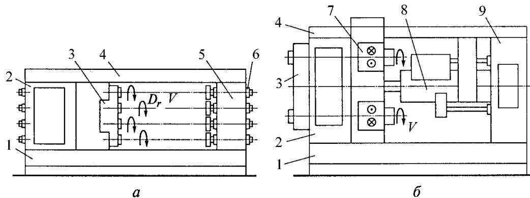
Рис. 10.17. Горизонтальные токарные автоматы: *а* – четырехшпиндельный параллельного действия; *б* – многошпиндельный последовательного действия; 1 – станина; 2 – передняя стойка; 3 – шпиндельный блок; 4 – траверса; 5, 9 – задние стойки; 6 – упоры; 7 – поперечный суппорт; 8 – осевой суппорт
