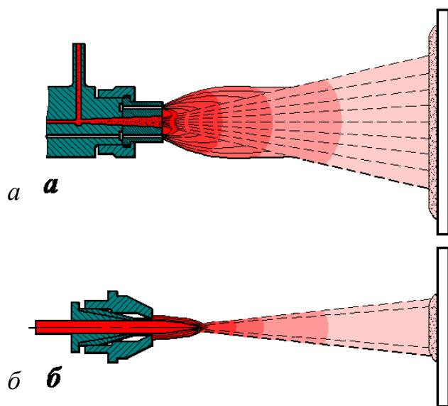
Рис. 12.2. Схема газопламенного нанесения покрытий:
