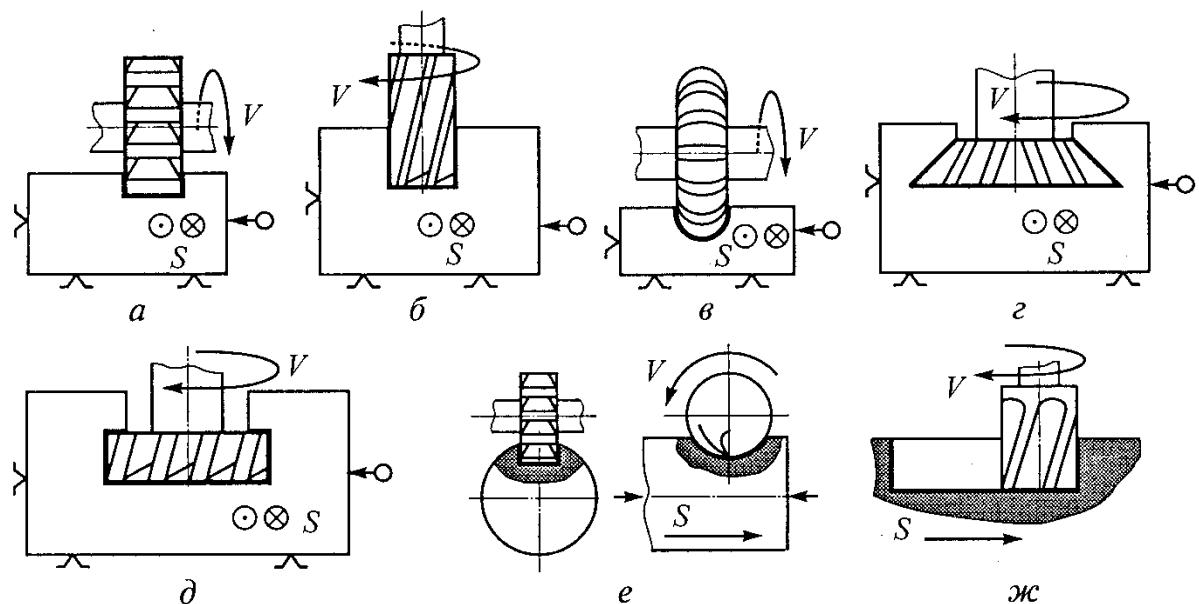
Рис. 10.42. Фрезерование пазов: *а, б* – прямоугольных; *в* – полукруглых; *г* – типа «ласточкин хвост»; *д* – Т-образных; *е, жс* – шпоночных
