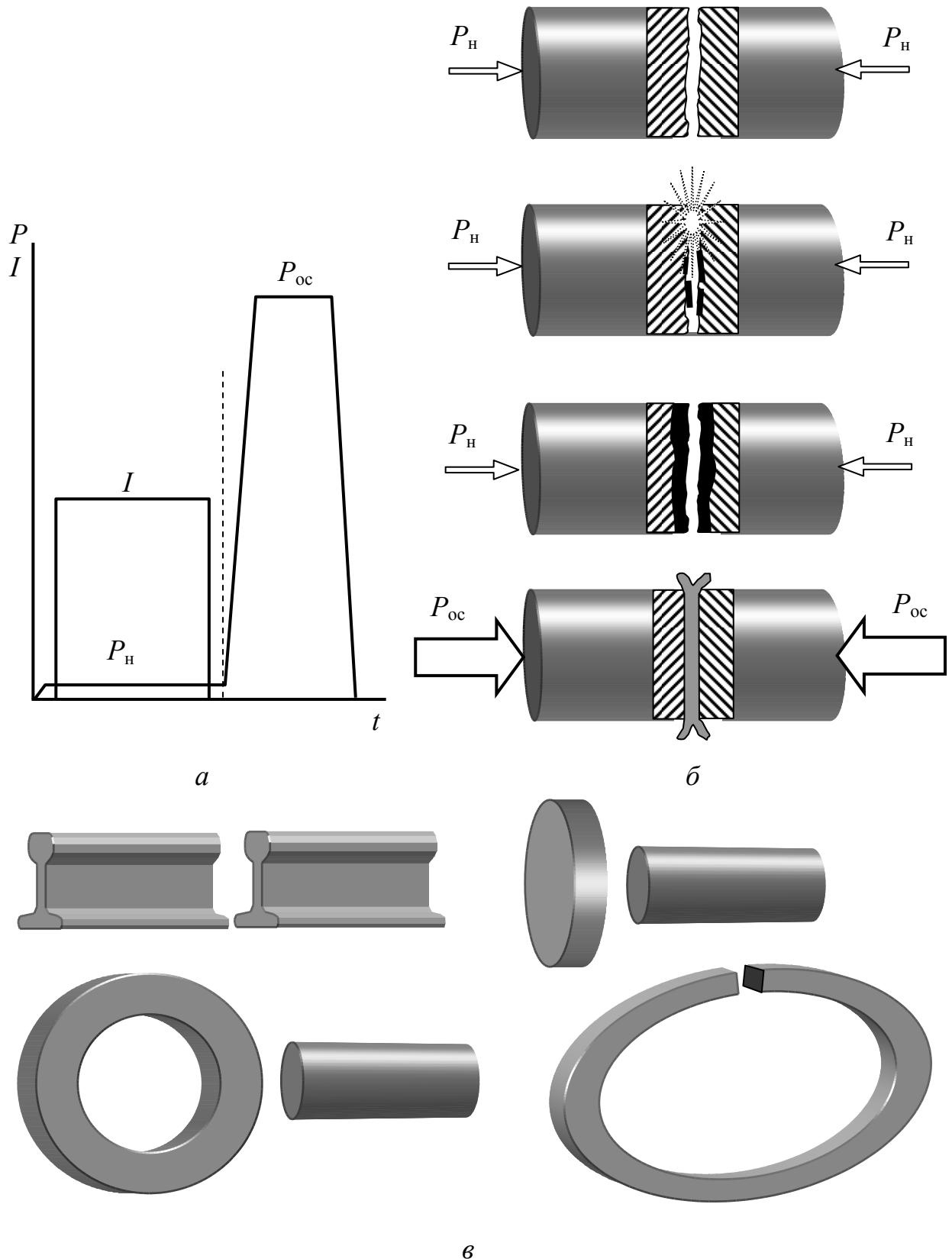
Рис. 7.24. Стыковая контактная сварка оплавлением:
