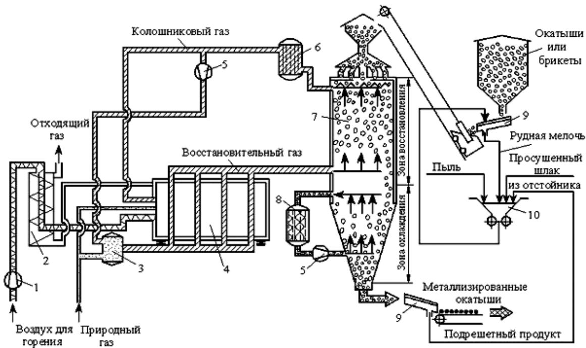
Рис. 3.9. Схема процесса получения губчатого железа в шахтной печи:
