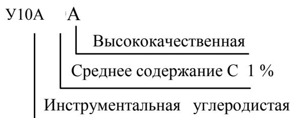
Рис. 2.25. Марка инструментальной стали
