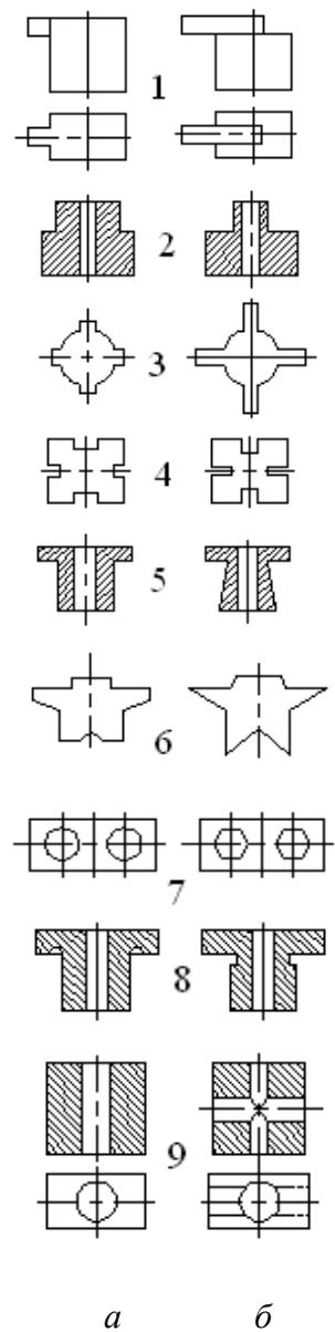
Рис. 9.8. Примеры конструкций порошковых заготовок:
