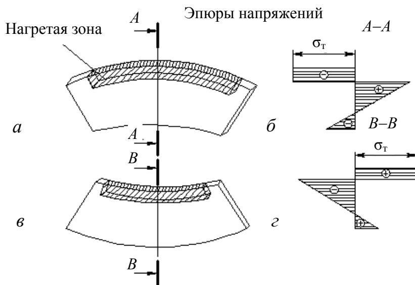
Рис. 7.30. Возникновение напряжений и деформаций при наплавке валика на кромку полосы металла: *а* – деформация полосы в процессе наплавки валика на кромку; *б* – эпюры распределения напряжений в полосе при наплавке; *в* – деформация полосы после остывания; *г* – эпюры распределения напряжений в полосе с наплавленной кромкой;  $\sigma_t$  – предел текучести материала полос
