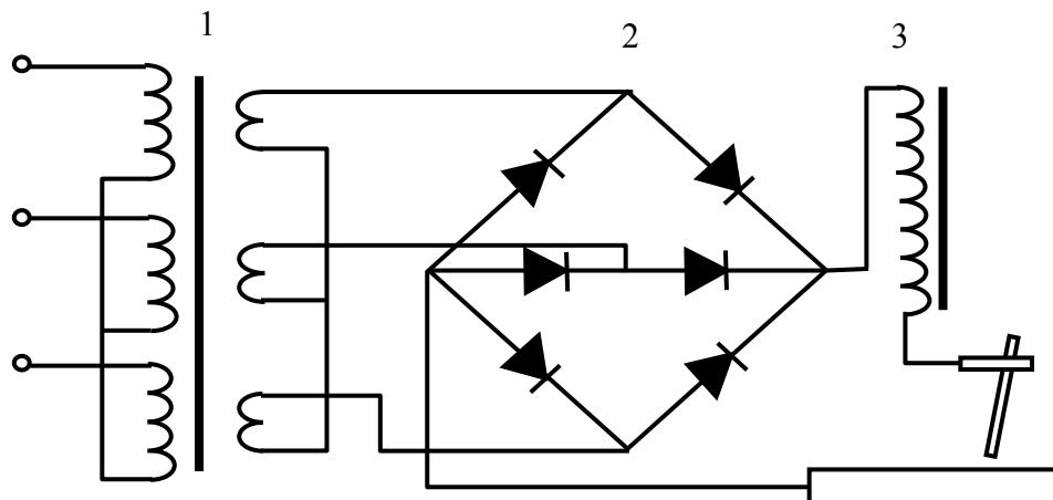
Рис. 7.10. Схема трехфазного выпрямителя
