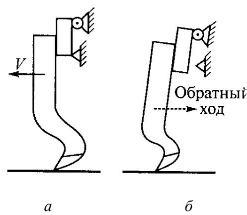
Рис. 10.54. Установка строгального резца на качающейся плате: *а* – прямой ход; *б* – обратный ход
