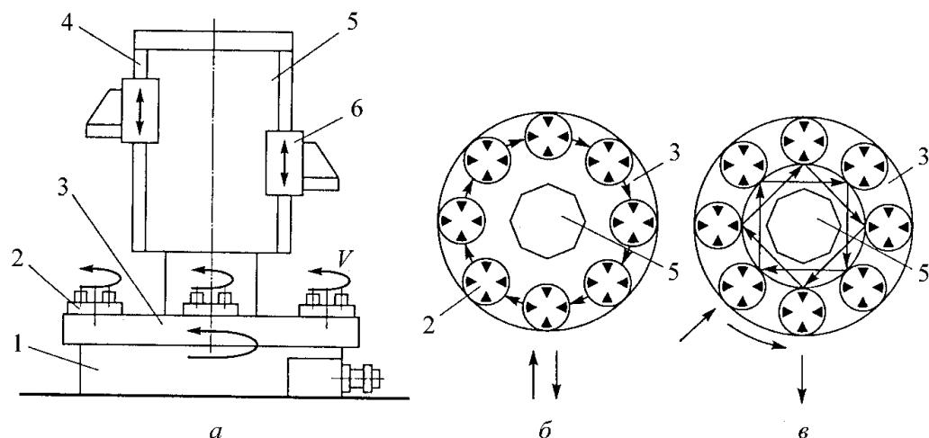
Рис. 10.18. Вертикальный многошпиндельный полуавтомат: *а* – компоновка станка; *б* – одинарная индексация карусели; *в* – двойная индексация карусели; 1 – станина; 2 – шпиндель; 3 – карусель; 4 – вертикальные направляющие; 5 – центральная колонна; 6 – суппорты
