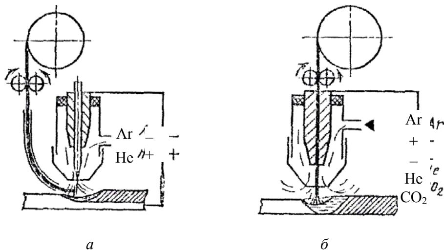
Рис. 7.12. Схема сварки в защитных газах: *а* – неплавяющимся электродом; *б* – плавяющимся электродом
