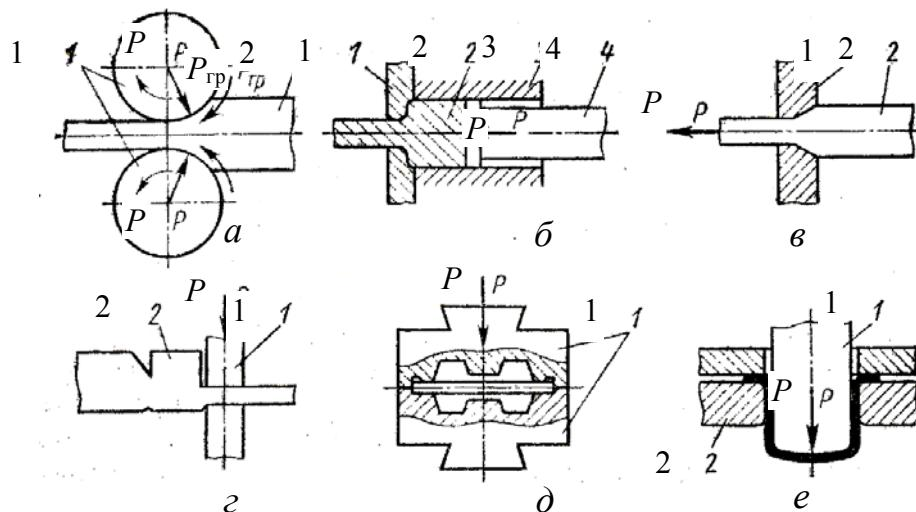
Рис. 6.1. Схемы основных видов обработки металлов давлением
