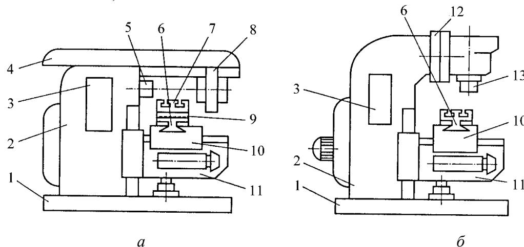
Рис. 10.47. Универсальные фрезерные станки: *а* – горизонтально-фрезерный; *б* – вертикально-фрезерный; 1 – фундаментная плита; 2 – станина; 3 – коробка скоростей; 4 – хобот; 5 – шпиндельный узел; 6 – поперечные салазки; 7 – стол; 8 – серьга; 9 – поворотные салазки; 10 – продольные салазки; 11 – консоль; 12 – поворотная планшайба; 13 – шпиндель
