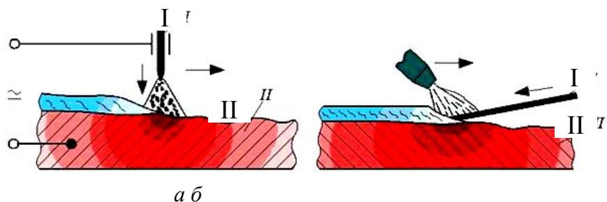
Рис. 12.1. Схема дуговой наплавки: *а* – покрытым электродом;
