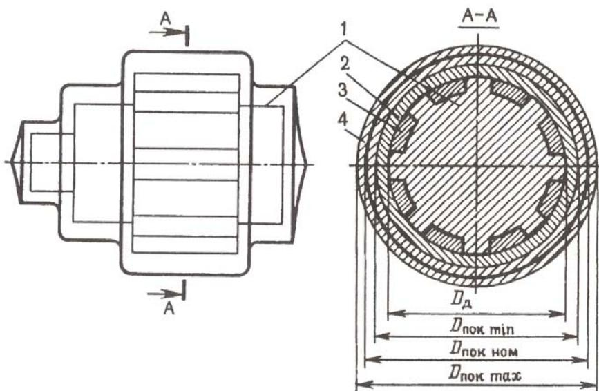
Рис. 6.29. Схема размеров поковки: 1 – детали; 2 – припуска; 3 – напуска; 4 – допуска
