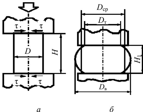
Рис. 6.42. Схема осадки: *a* – исходная заготовка; *б* – поковка после осадки
