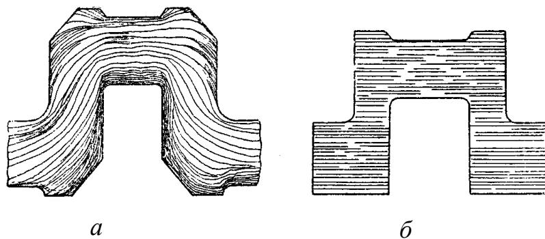
Рис. 6.11. Макроструктура продольно разрезанного коленчатого вала:
