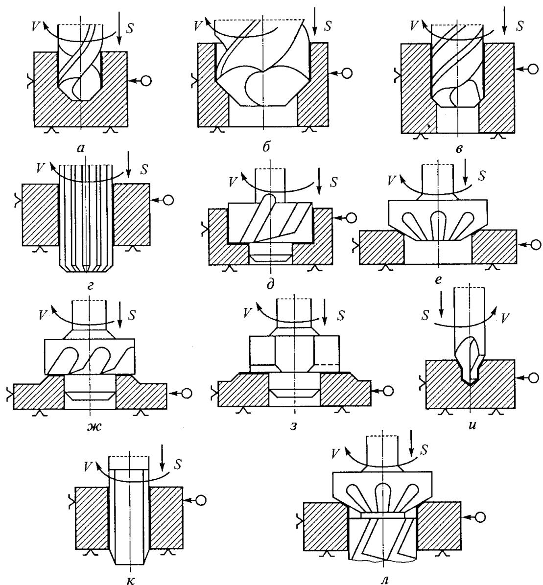
Рис. 10.21. Схемы обработки поверхностей на сверлильных станках: *a* – сверление; *b* – рассверливание; *c* – зенкерование; *d* – развертывание; *e* – зенкование; *жс*, *з* – цекование; *и* – обработка базовых центровых отверстий; *к* – нарезание внутренних резьб; *л* – обработка сложных поверхностей
