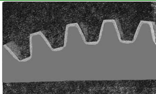
Рис. 12.3. Толщина цементованного слоя зубчатого колеса
