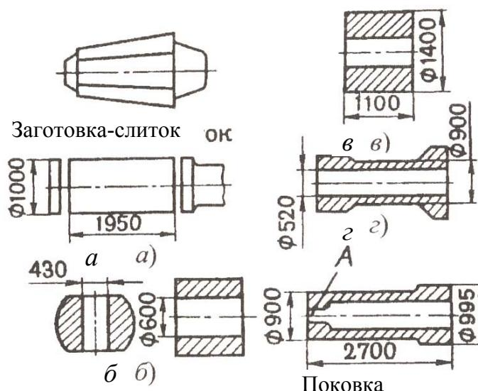
Рис. 6.30. Последовательность операций ковки полого цилиндра из слитка
