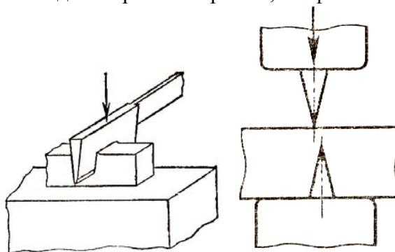
Рис. 6.40. Отрубка с поворотом заготовки
