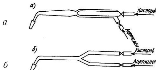
Рис. 7.16. Схемы газовых горелок: а – инжекторной; б – безинжекторной
