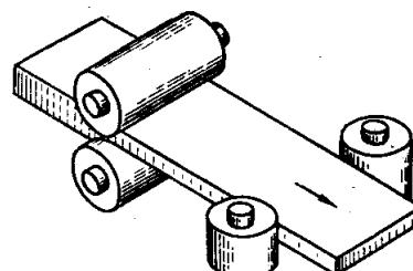
Рис. 6.22. Схема универсального прокатного стана
