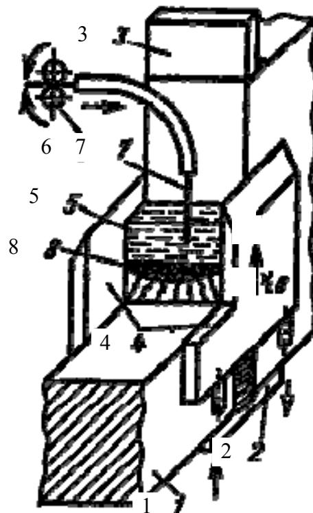
Рис. 7.13. Схема электрошлаковой сварки
