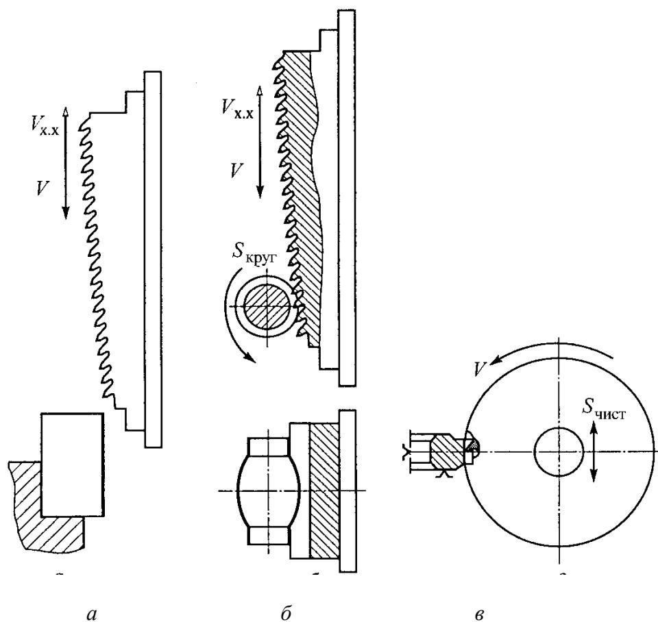
Рис. 10.36. Схемы протягивания наружных поверхностей:
