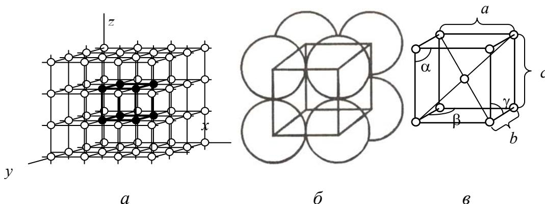
Рис. 2.1. Расположение атомов (ионов): *а* – в кристаллической решетке; *б, в* – в элементарной кристаллической ячейке
