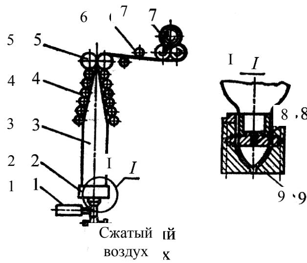
Рис. 9.11. Схема получения пленки методом раздувки: *1* – экструдер; *2* – формующая головка; *3* – рукав пленки; *4*, *6* – направляющие ролики; *5* – тянувшие ролики; *7* – рулоны с пленкой; *8* – донр (канал для подачи сжатого воздуха); *9* – канал для подачи расплавленного полимера
