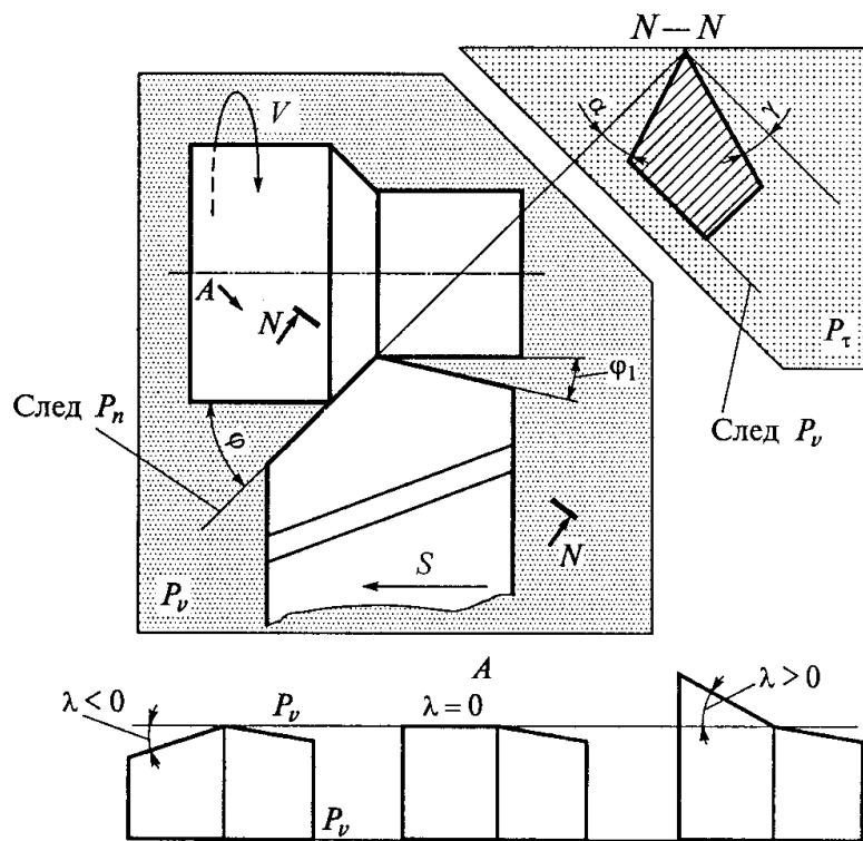
Рис. 10.5. Углы резца в статической системе координат:  $V$  – движение резания;  $S$  – движение подачи;  $P_v$  – основная плоскость;  $P_n$  – плоскость резания;  $P_\tau$  – главная секущая плоскость;  $\alpha$ ,  $\gamma$  – главные задний и передний углы;  $\varphi$ ,  $\varphi_1$  – главный и вспомогательный углы в плане;  $\lambda$  – угол наклона главной режущей кромки
