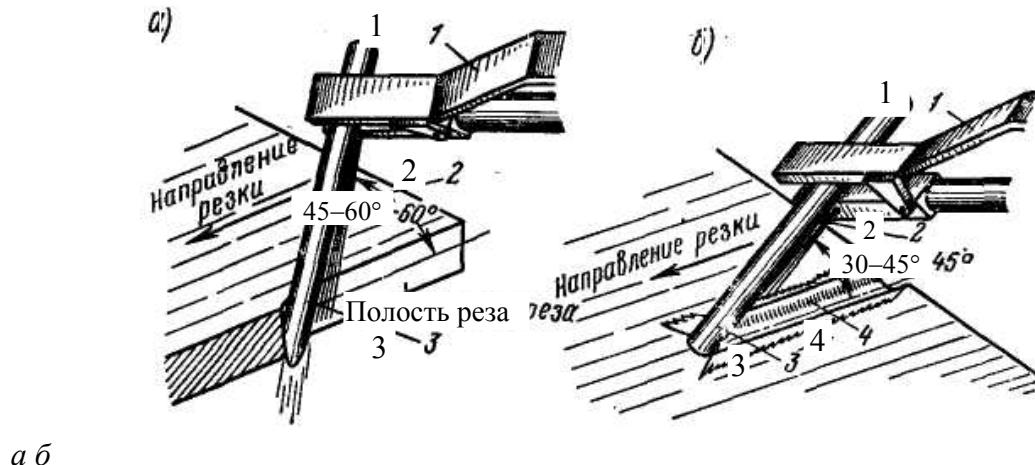
Рис. 7.18. Воздушно-дуговая резка: а – разделительная; б – поверхностная
