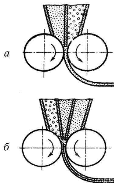
Рис. 9.6. Методы прокатки порошков: *а* – двухслойной; *б* – трехслойной
