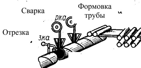
Рис. 6.24. Схема получения труб электродуговой сваркой под флюсом
