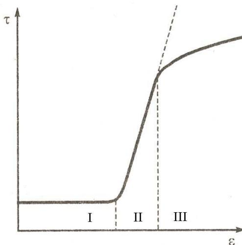
Рис. 6.5. Диаграмма деформирования монокристалла:
