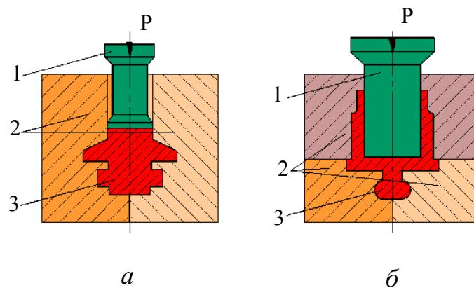
Рис. 6.47. Схема изготовления поковок в закрытых штампах с разъемной матрицей:
