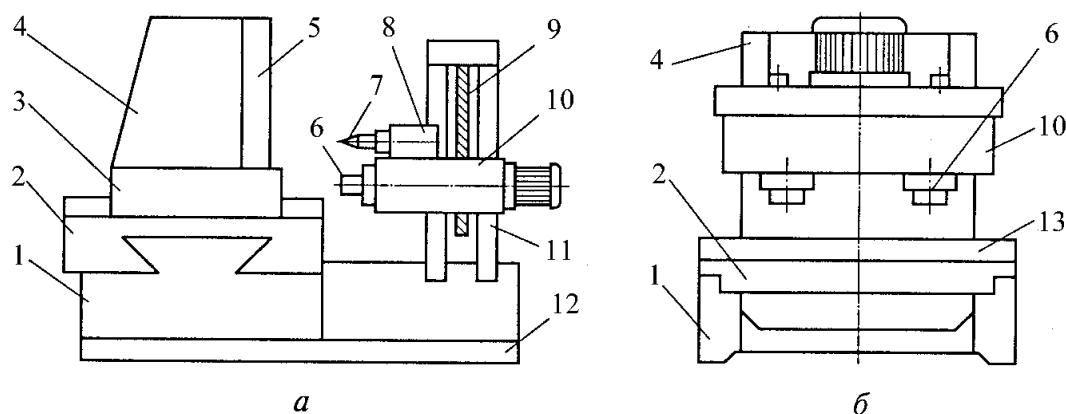
Рис. 10.48. Специальные фрезерные станки: *а* – копировально-фрезерный; *б* – карусельно-фрезерный; 1 – станина; 2 – салазки; 3 – горизонтальный стол; 4, 11 – стойки; 5 – вертикальный стол; 6 – шпиндель; 7 – щуп; 8 – следящий привод; 9 – механизм подачи; 10 – фрезерная головка (бабка); 12 – фундаментная плита; 13 – карусель
