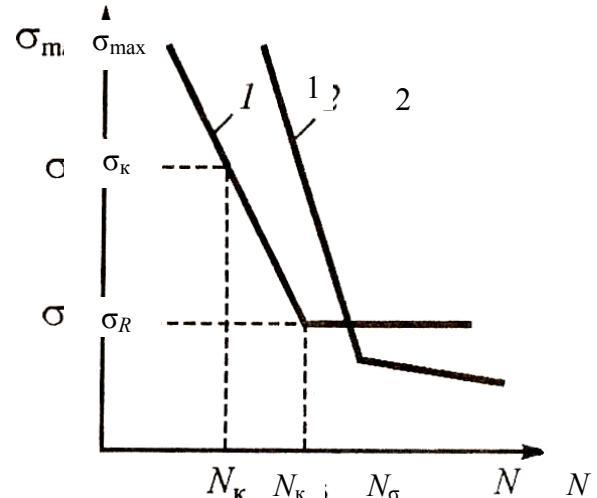
Рис. 2.20. Кривые усталости для стали (1) и цветных металлов (2)
