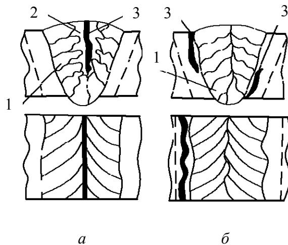
Рис. 7.2. Вид трещин сварных соединений: *a* – горячих; *б* – холодных;
