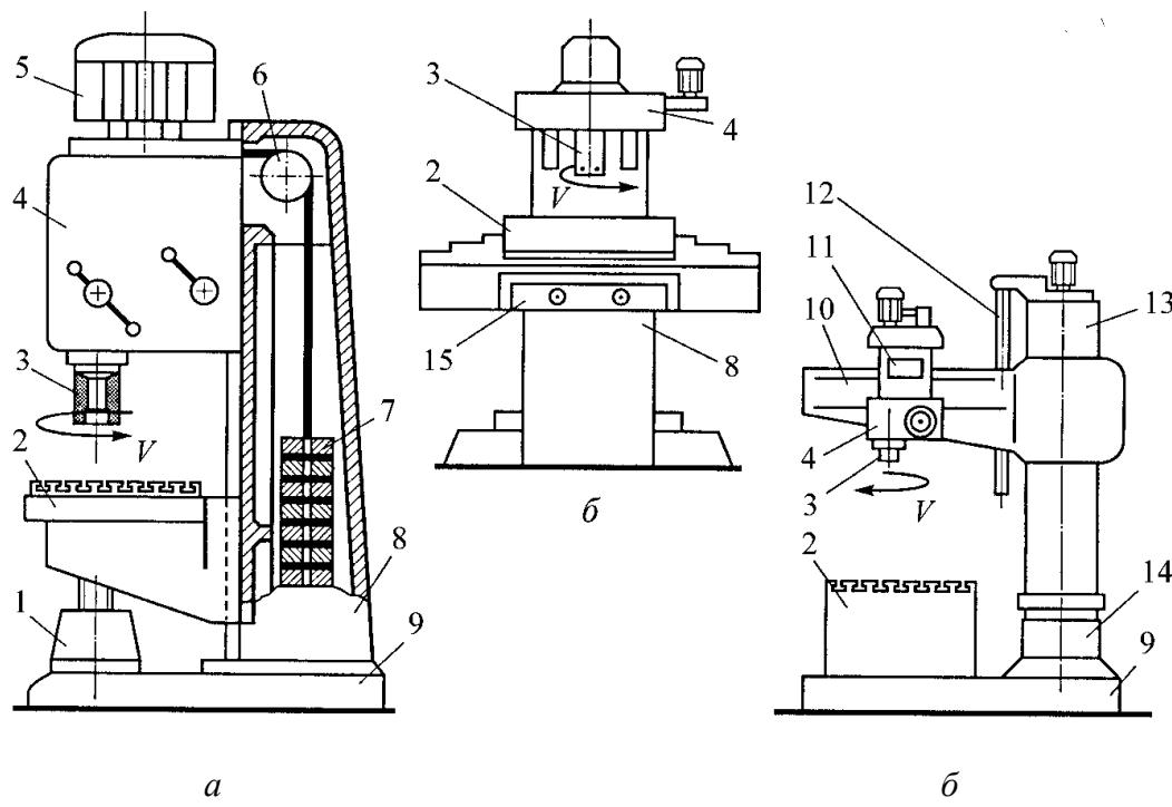
Рис. 10.25. Станки сверлильной группы: *а* – вертикально-сверлильный станок; *б* – вертикально-сверлильный станок с ЧПУ; *в* – радиально-сверлильный станок; 1 – домкрат; 2 – стол; 3 – шпиндель; 4 – сверлильная головка; 5 – электродвигатель; 6 – блок; 7 – противовес; 8 – вертикальная станина (колонна); 9 – фундаментная плита; 10 – траверса; 11 – коробка скоростей; 12 – винтовой механизм; 13 – гильза; 14 – тумба; 15 – салазки; *V* – движение резания
