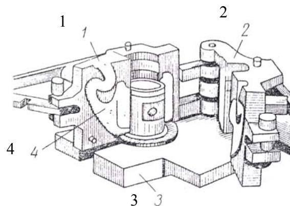
Рис. 5.20. Форма для изготовления алюминиевого поршня
