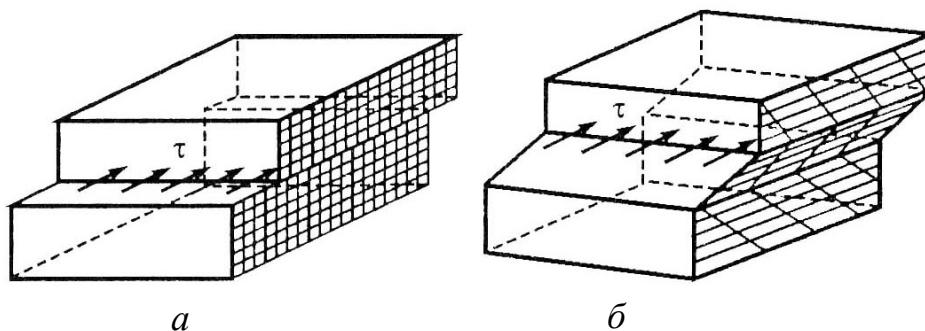
Рис. 6.2. Схемы пластической деформации: *а* – скольжения; *б* – двойникования
