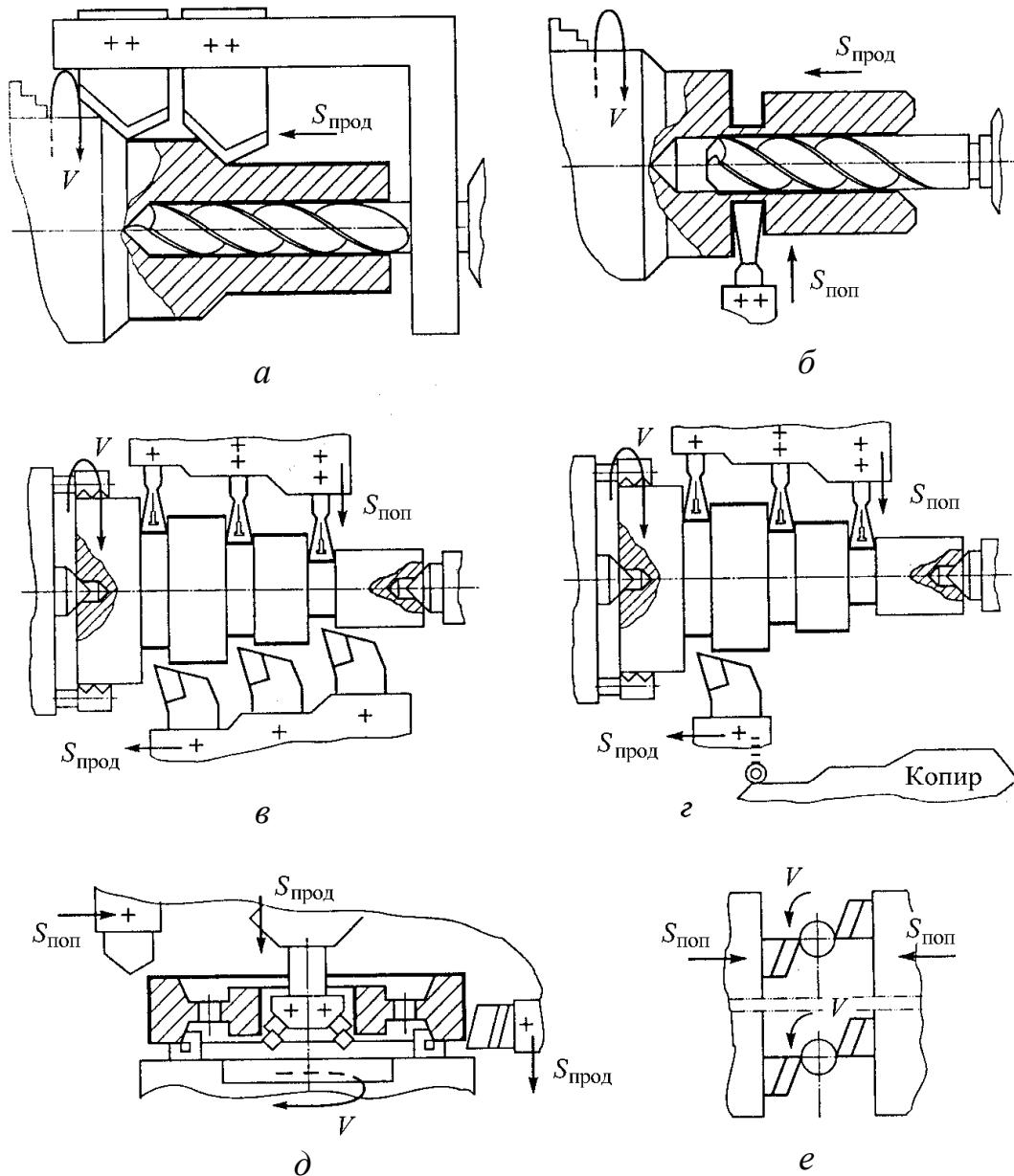
Рис. 10.19. Примеры наладок на станках токарной группы: *a*, *б* – на токарно-револьверном станке; *в* – на горизонтальном одношпиндельном автомате; *г* – на гидрокопировальном автомате; *д* – на вертикальном многошпиндельном автомате; *е* – на горизонтальном многошпиндельном автомате
