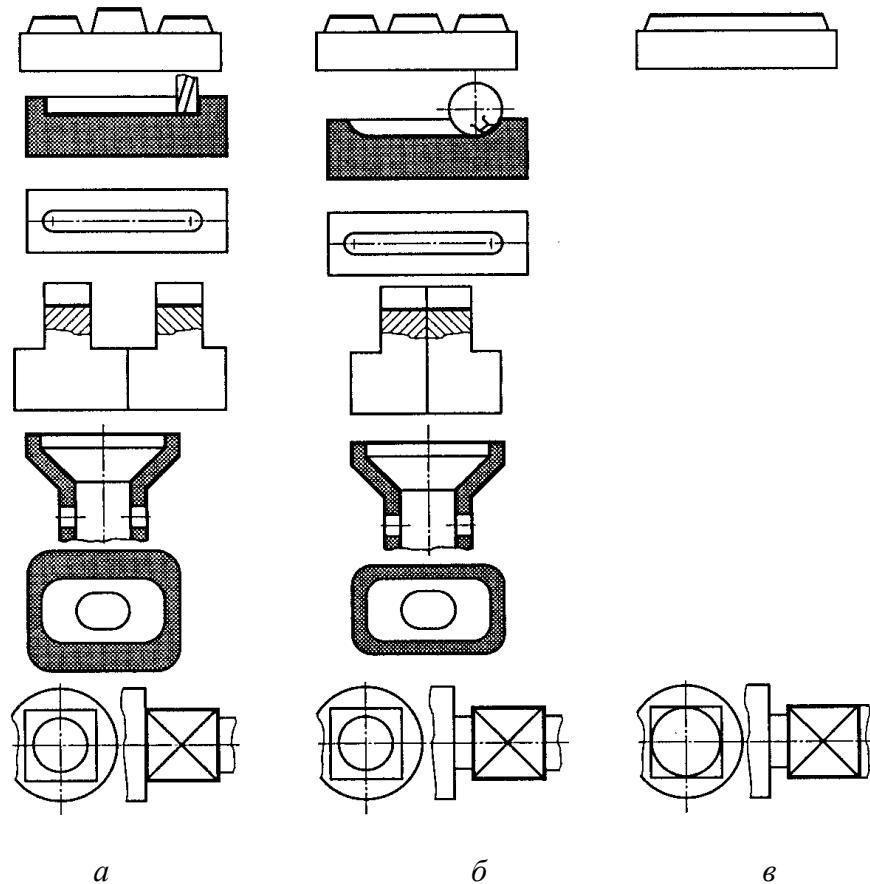
Рис. 10.51. Технологические требования к деталям, обрабатываемым на станках фрезерной группы: *a* – нетехнологичные конструкции; *b* – технологичные конструкции; *c* – наиболее технологичные решения
