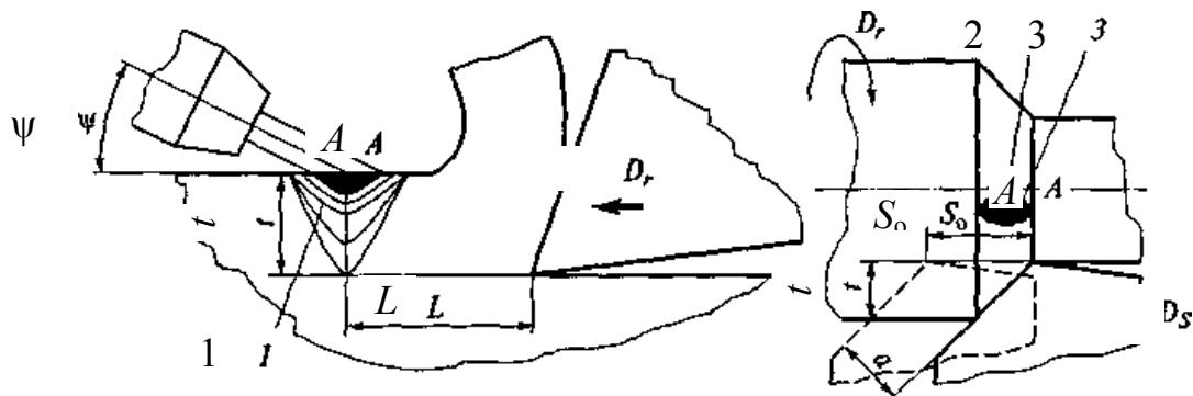
Рис. 11.11. Плазменно-механическая обработка: 1 – зона интенсивного нагрева; 2 – центральная точка нагрева; 3 – анодное пятно контакта;  $a$  – толщина срезаемого слоя;  $L$  – величина запаздывания механического воздействия;  $t$  – глубина резания;  $\psi$  – угол наклона плазмотрона
