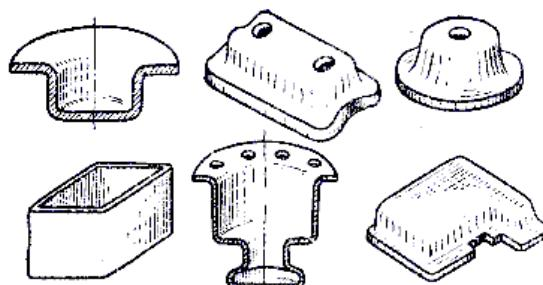
Рис. 6.56. Детали, получаемые вытяжкой
