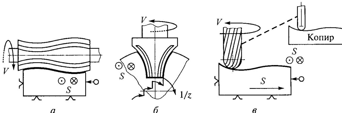
Рис. 10.43. Фрезерование фасонных поверхностей: *а, б* – методом копирования цилиндрической и концевой (пальцевой) фрезой соответственно; *в* – по копиру
